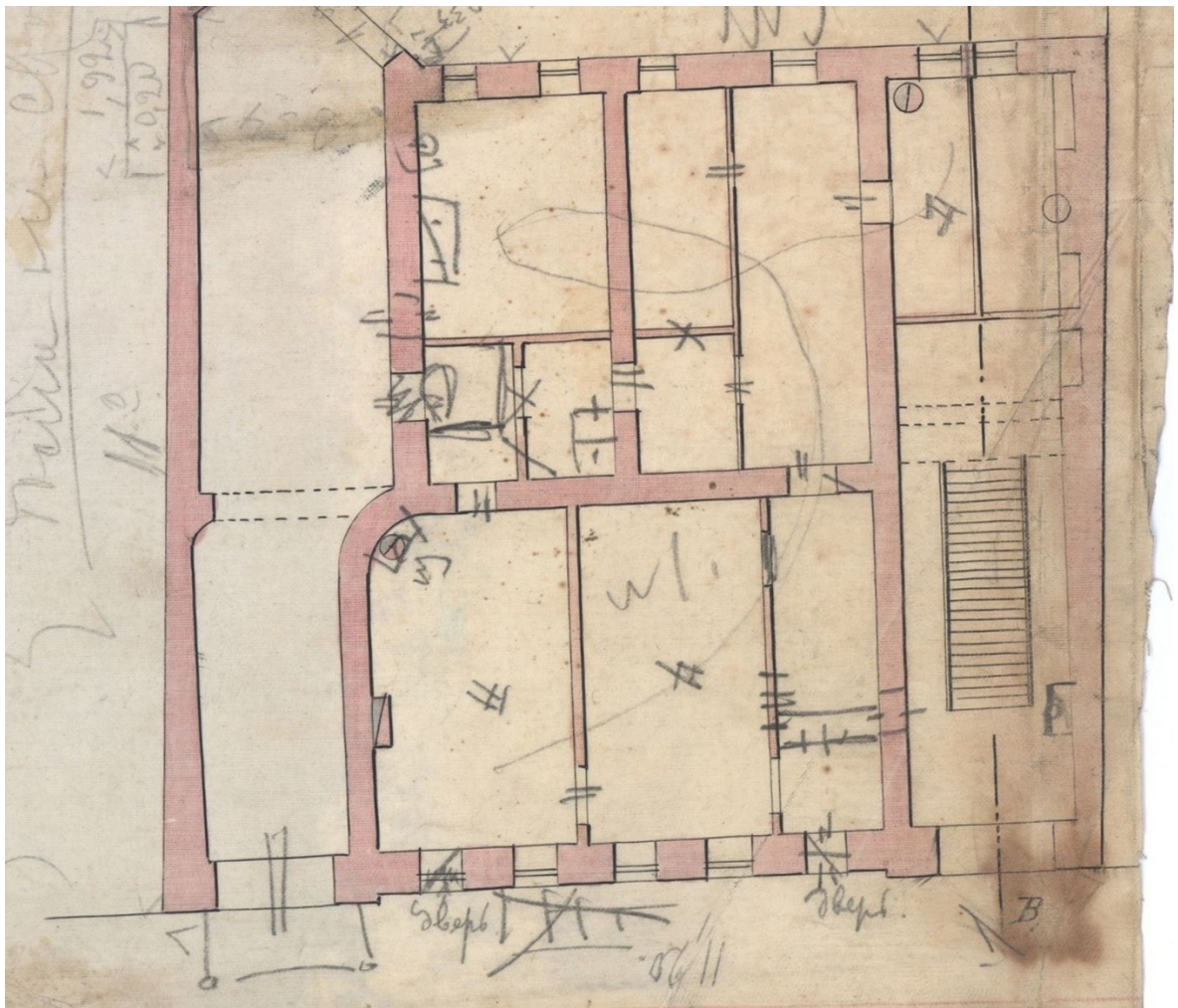
12. Моховая улица, участок № 48/15. Проект архитектора Л. Бонштедта 1851 г. - первый вариант проекта. ЦГИА СПб Фонд 515, Описание 4, Дело 3580, Листы 1 – 4. Фрагмент плана 1 этажа лицевого корпуса по Моховой ул., запроектированы два (непарадных) входа по 2 и 6 осям.
