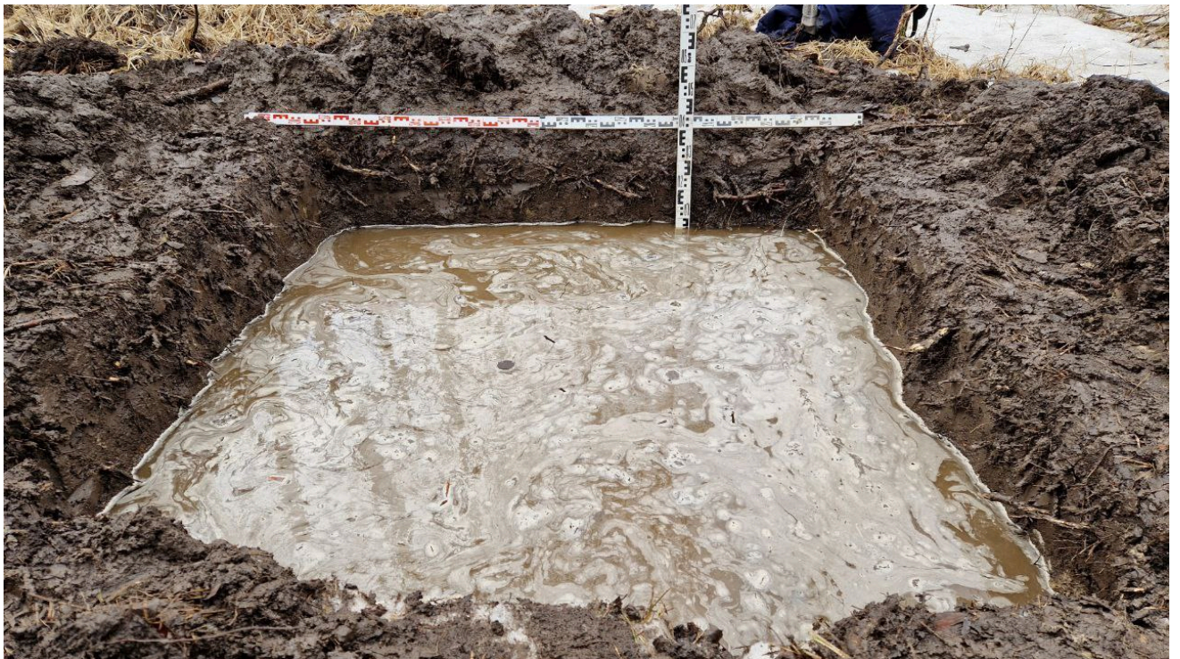
Рис. 43. Санкт-Петербург, Колпинское шоссе, Реконструкция Колпинского шоссе на участке от автодороги М- 10 «Россия» до Софийской ул. Шурф 2. Фиксация по уровню грунтовых вод. Южная стенка.
