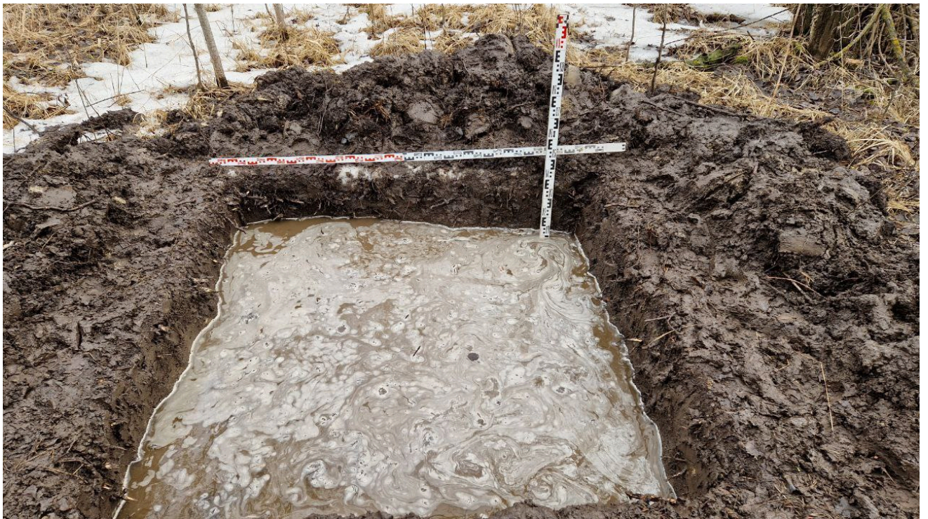
Рис. 39. Санкт-Петербург, Колпинское шоссе, Реконструкция Колпинского шоссе на участке от автодороги М- 10 «Россия» до Софийской ул. Шурф 2. Фиксация по уровню грунтовых вод. Вид на восток.
