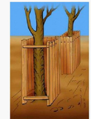
Рис.3. Вариант устройства короба защитного из досок.
