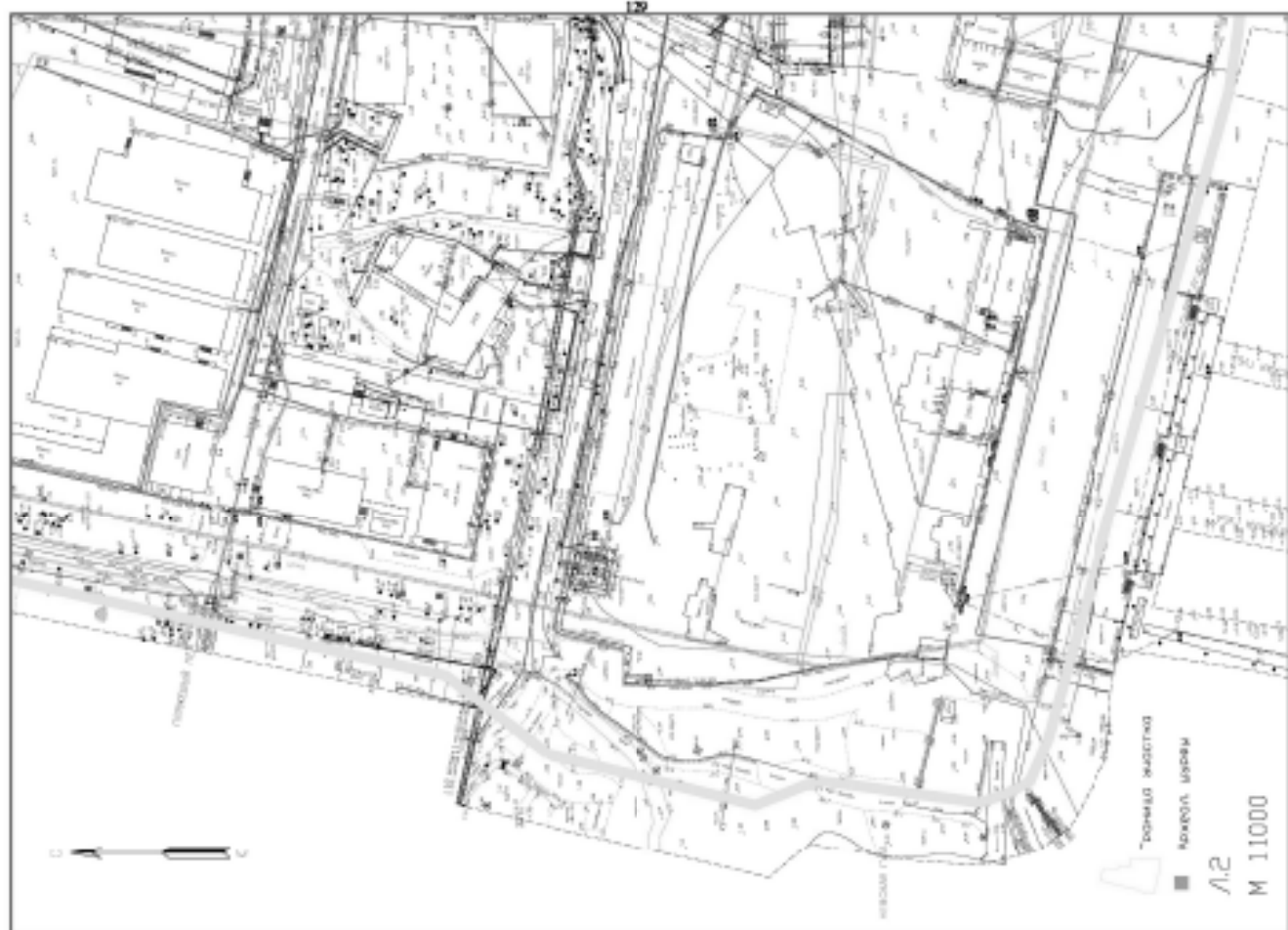
Рис. 20 Топографический план участка обследования, предоставляемый заказчиком работ. На плане отмечены места археологических шурфов. Масштаб 1:1000. Лист 2 из 3.
