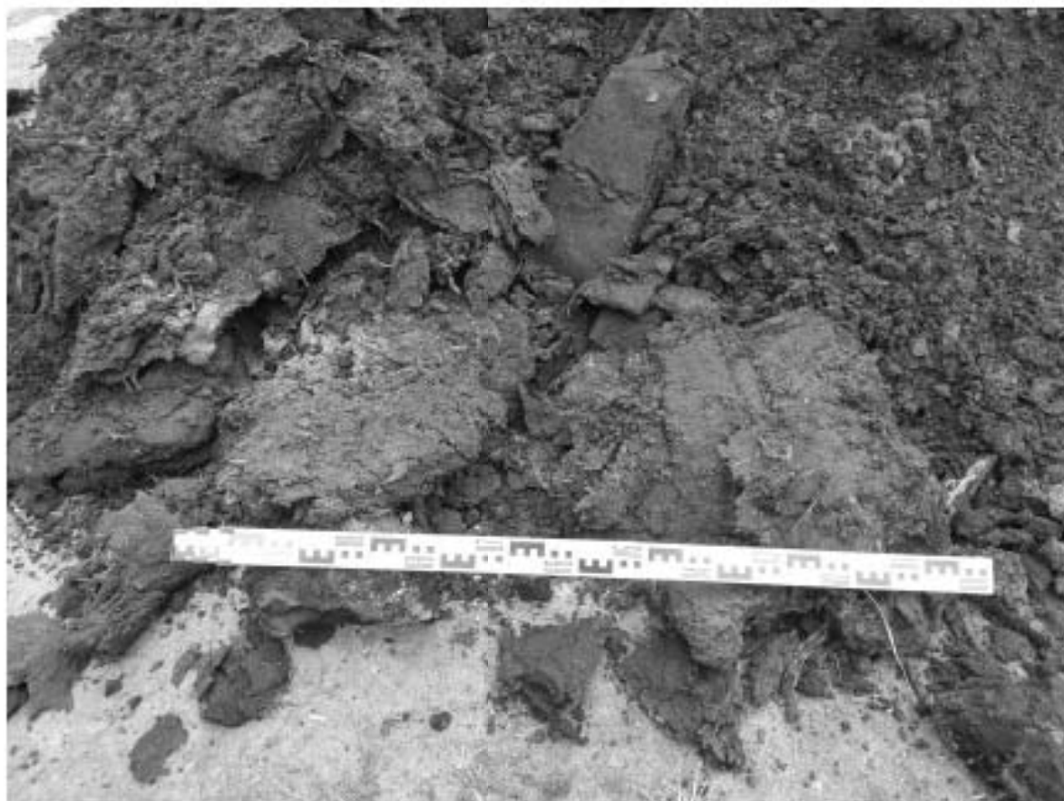
Илл. 49. Санкт-Петербург, Евгеньевская ул., д. 2, лит. А. Шурф 2. Отвал напластований стерильного торфа.
