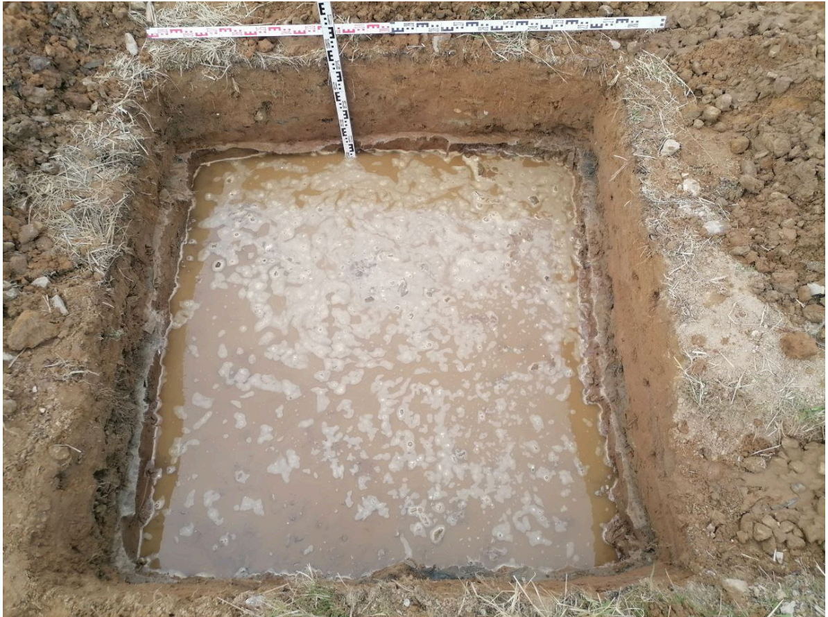
Рис. 35 Санкт-Петербург, пос. Шушары, Колпинское шоссе, участок 168 (квартал II)» (кадастровый номер: 78:42:0018304:19566) Шурф 2. Фиксация по уровню грунтовых вод.
