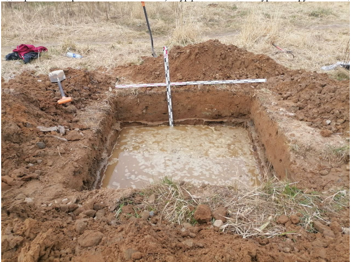
Рис. 36 Санкт-Петербург, пос. Шушары, Колпинское шоссе, участок 168 (квартал II)» (кадастровый номер: 78:42:0018304:19566) Шурф 2. Фиксация по уровню грунтовых вод. Вид на север.
