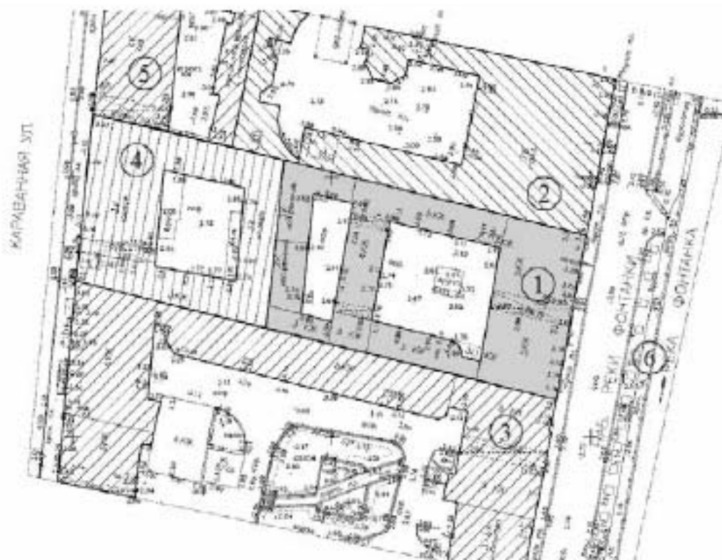
Рис. 1.1. Ситуационный план расположения реконструируемого здания с обозначением зданий, расположенных в зоне влияния строительства (обозначения нумерации зданий см. таблица 1.1.)
