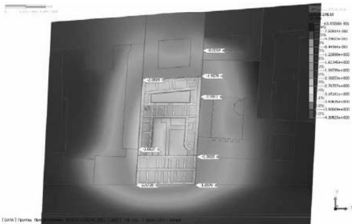
Рис. 4.1.7. Изополя суммарных вертикальных деформаций (значения в мм)
