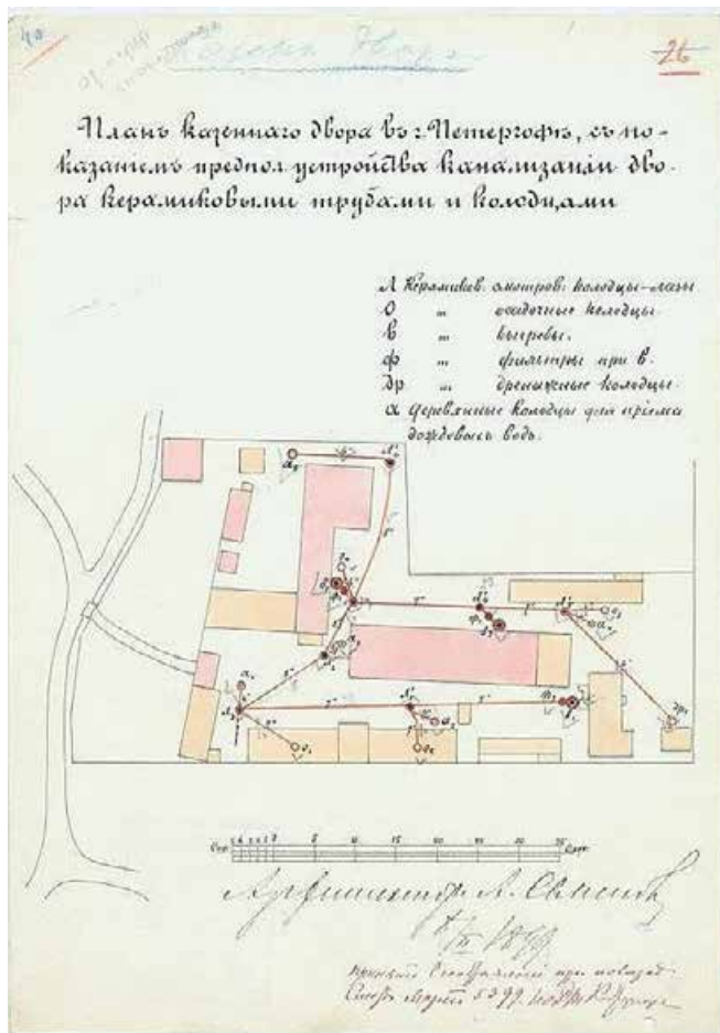
Илл. 42. План казенного двора в Петергофе с показанием канализации с колодцами, предполагаемой к устройству. 08.02.1899. Арх. А. И. Семенов. ГМЗ «Петергоф». ПДПМ 4254-ар
