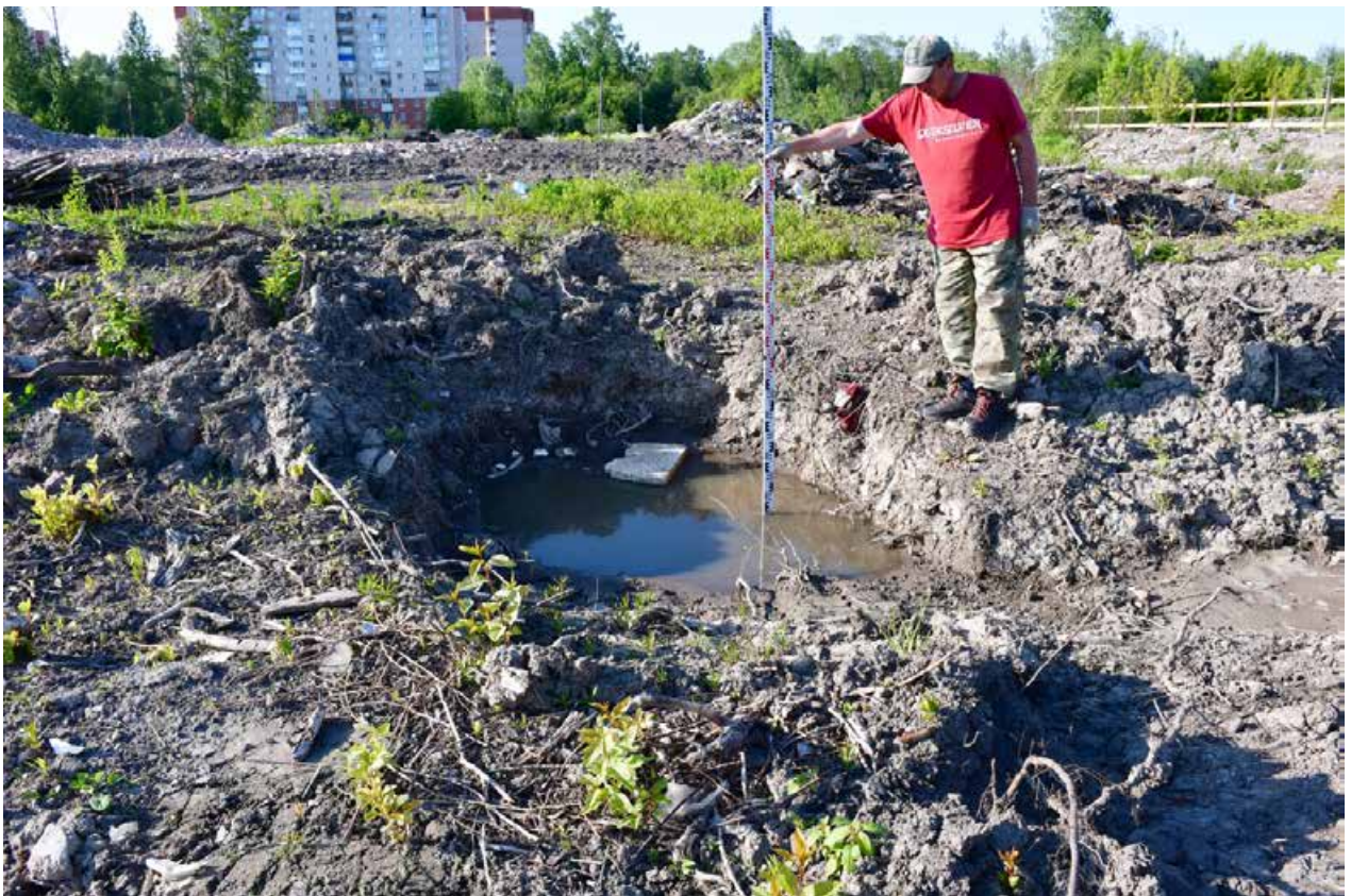
Илл. 17. г. Санкт-Петербург, ул. Тамбасова. Земельный участок с кадастровым номером 78:40:0008472:7780. Точка фото-фиксации №4. Уровень грунтовых вод. Вид с юга.
