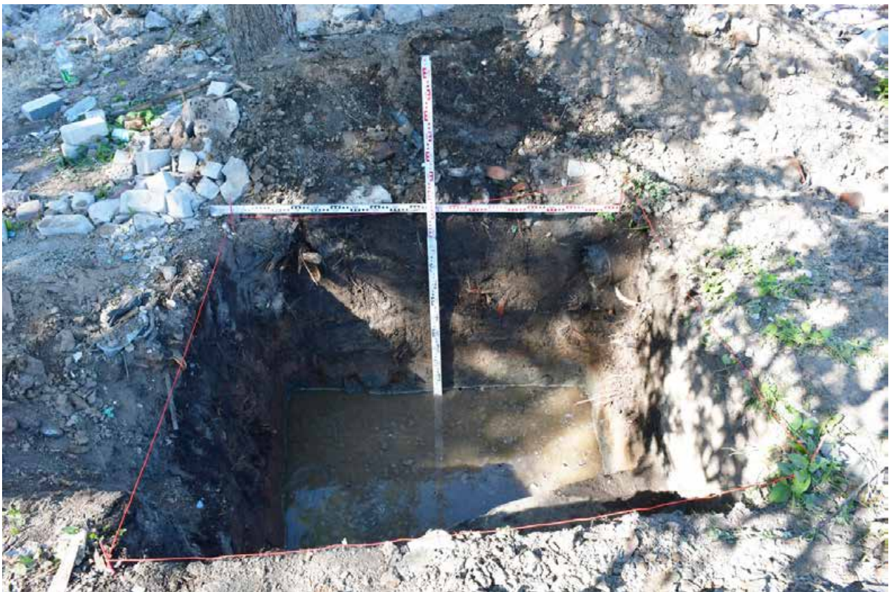
Илл. 32. г. Санкт-Петербург, ул. Тамбасова. Земельный участок с кадастровым номером 78:40:0008472:7776. Шурф №2. Уровень стояния грунтовых вод. Вид с юга.
