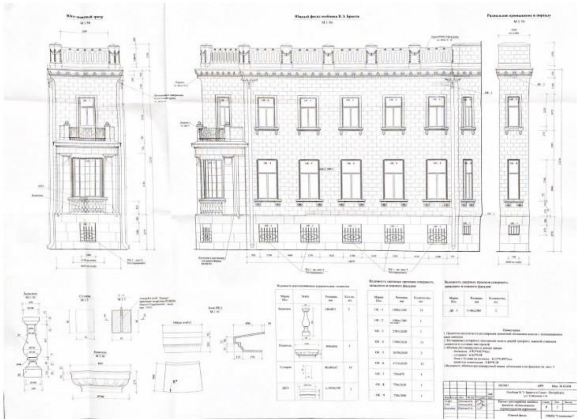
Илл. 62. Проект реставрации лицевых фасадов, облицованных керамическими изразцами. Чертеж. Южный фасад. РПНЦ «Специалист», 2007.
