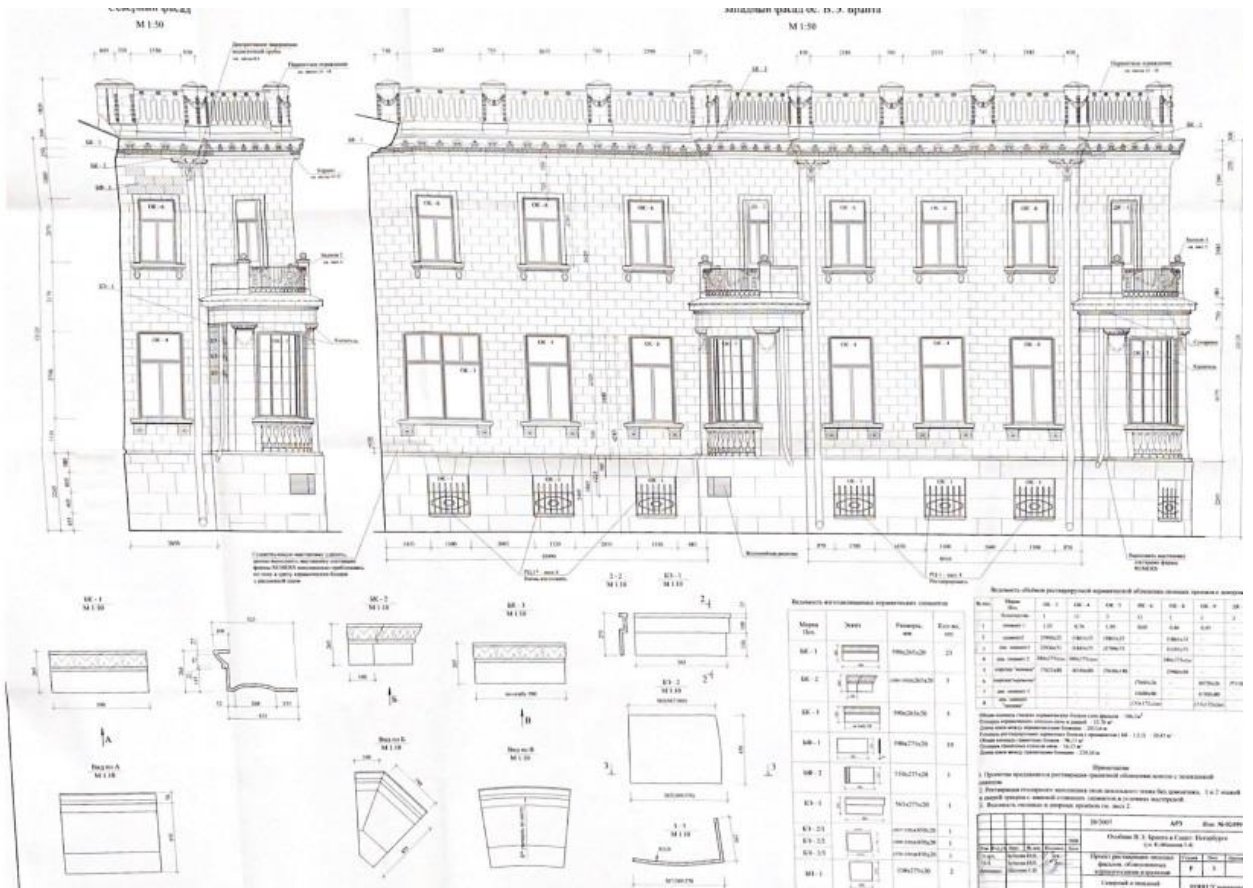
Илл. 63. Проект реставрации лицевых фасадов, облицованных керамическими изразцами. Чертеж. Северный и западный фасады. РПНЦ «Специалист», 2007.
