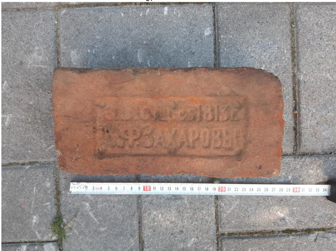
Рис. 23. Санкт-Петербург, Моховая ул. д. 34, лит. А. Шурф 1. Кирпич с клеймом из основания под бетонную стяжку.
