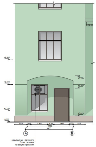
Проектируемый фасад с размещением доп. оборудования
