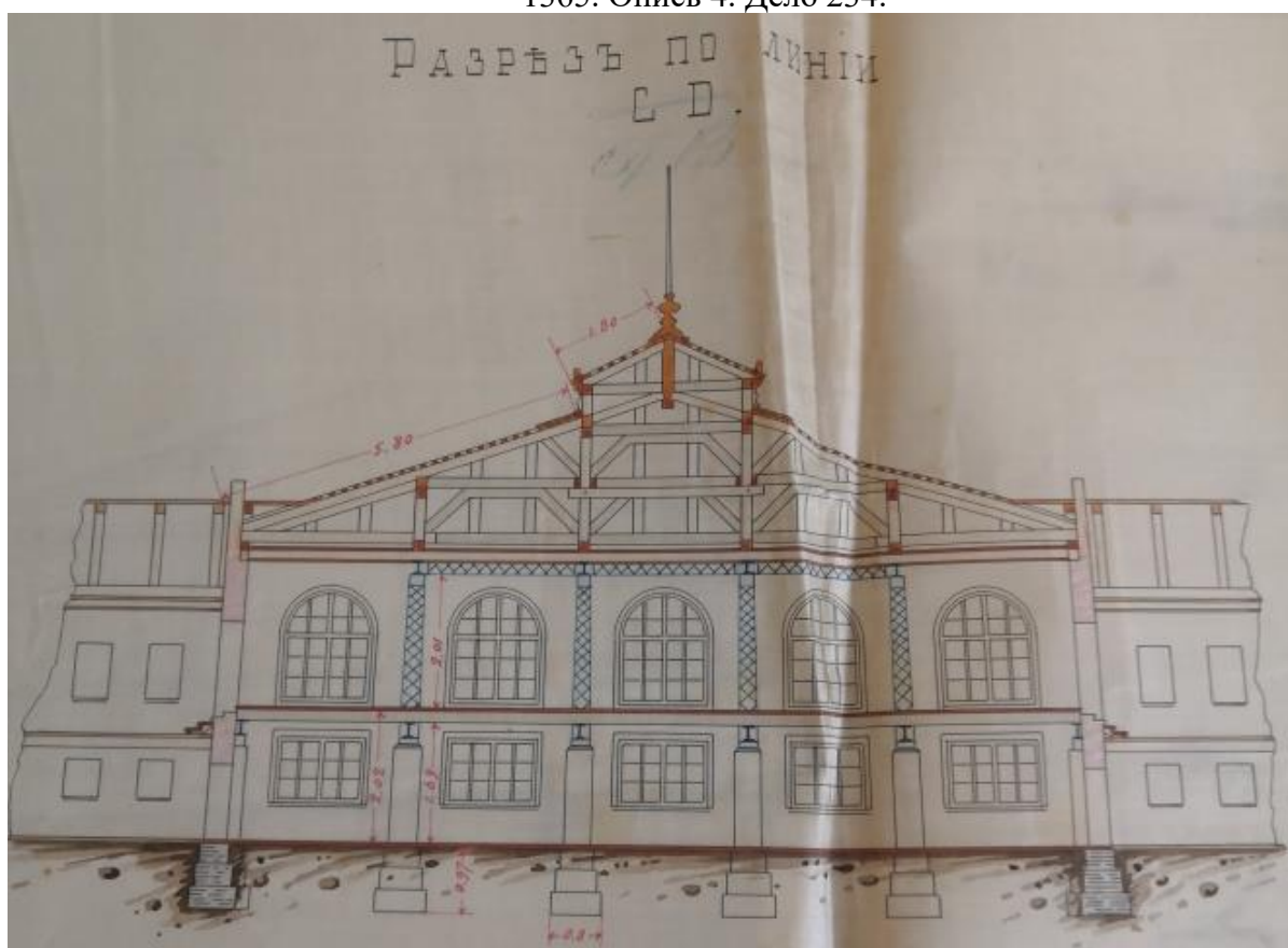
Илл. 24 Разрез С-Д. Проект перестройки пригоночной мастерской №2 на Александровском заводе. 1868 г. арх. Клевцинский А. А.// Архив ЦГИА. Фонд 1365. Описание 4. Дело 234.
