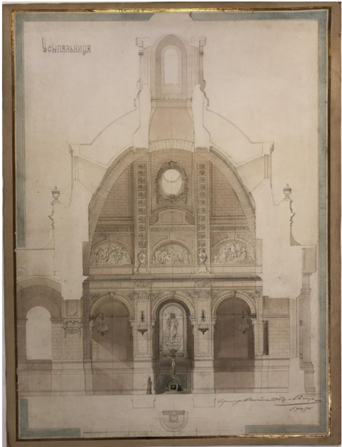
Илл. 4. Великокняжеская усыпальница. Петропавловская крепость. Проект. Поперечный разрез усыпальницы с планом алтаря. 1905 г. Автор проекта: Д.И. Гримм, архитектор Л.Н. Бенуа, архитектор А.О. Томишко. ФГБУК «Государственный научно-исследовательский музей архитектуры имени А.В. Щусева». ГНИМА ОФ-1478/1507
