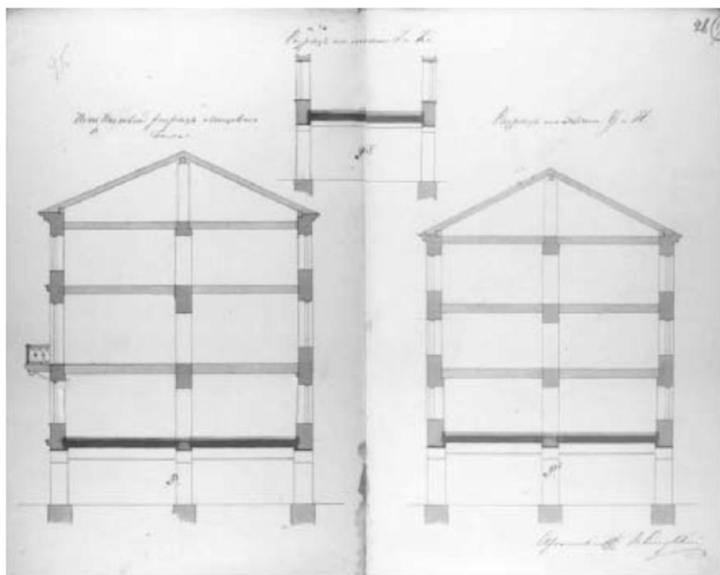
Илл.14. Разрез по линии J и К и G и H поперечный разрез лицевого дома. Архитектор В.Е. Стуккей. ЦГИА СПб Ф 513 Оп. 102. Д. 3309.
