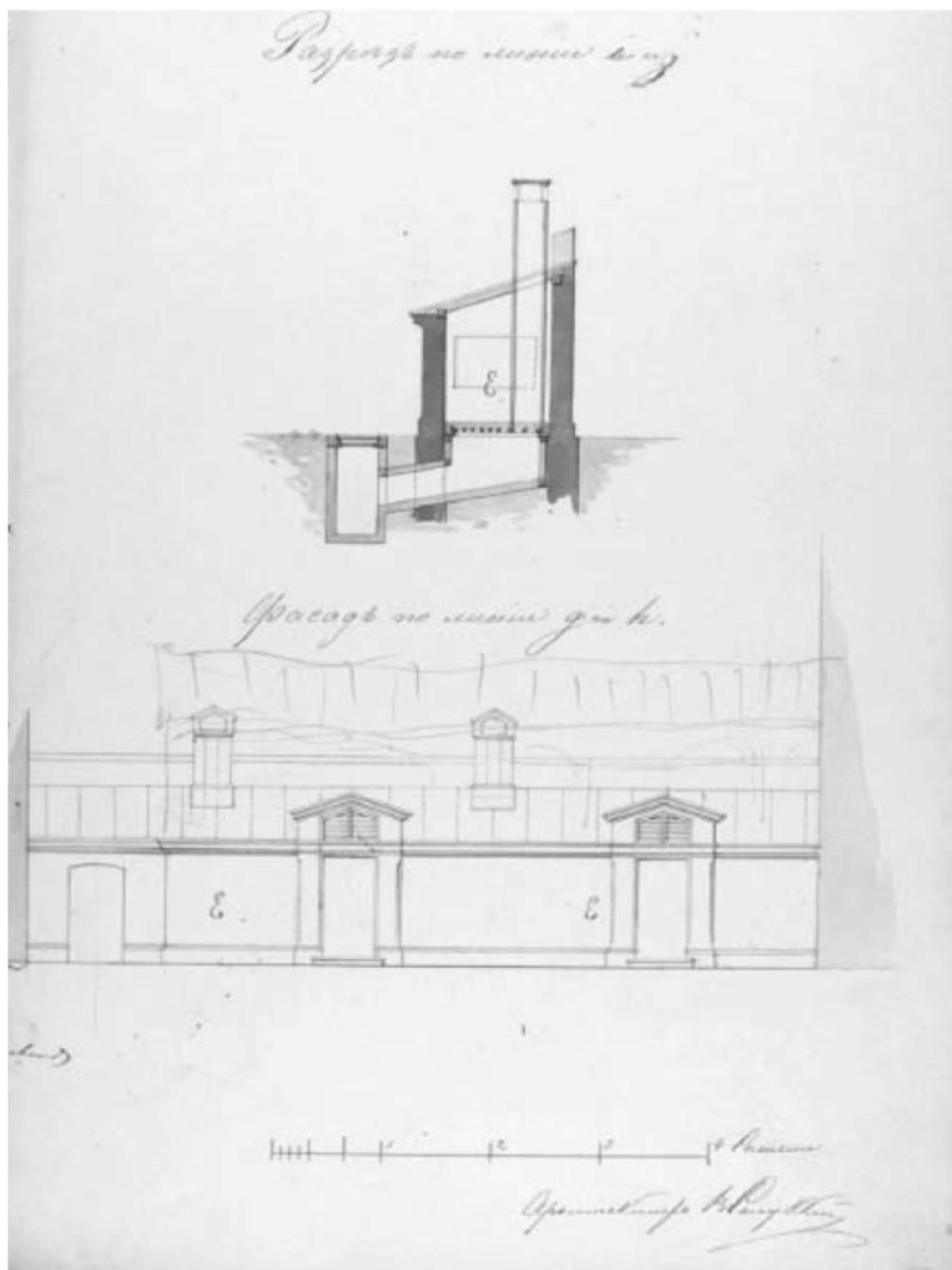
Илл. 8. Разрез по линии i и j. Фасад по линии g и h. Архитектор В.Е. Стуккей.
