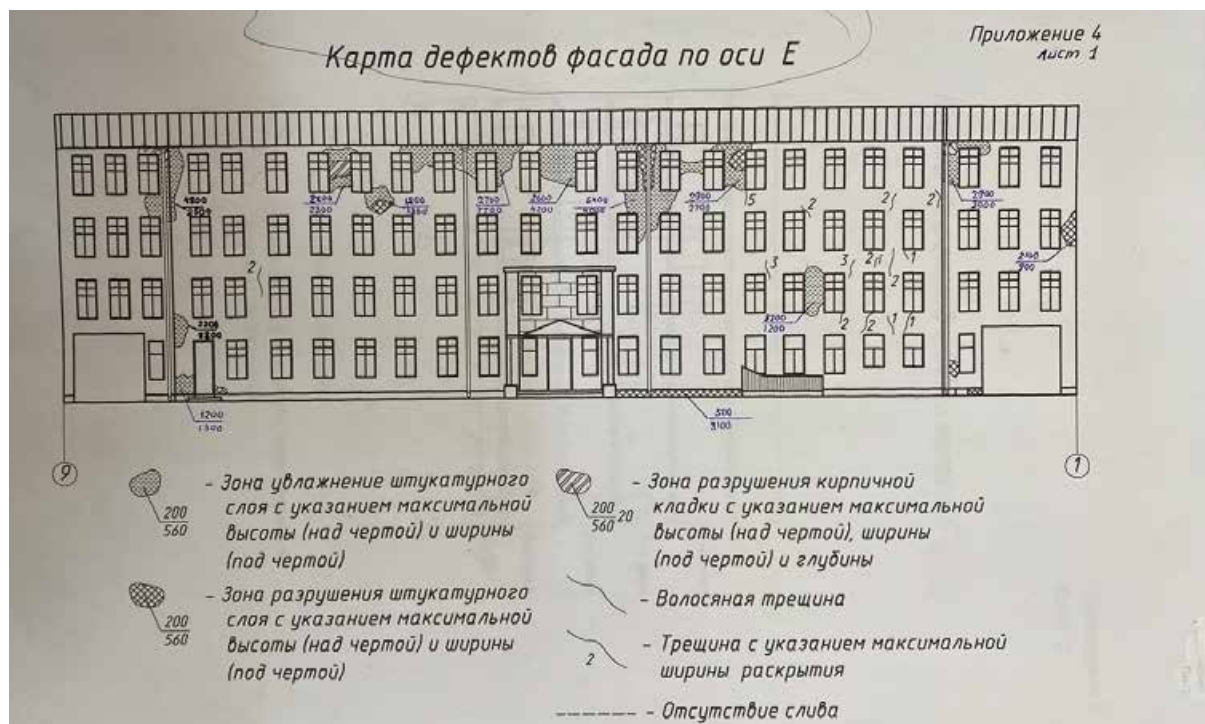
39. Карта дефектов фасада по оси Е. Технический отчет обследования конструкций здания ЛОККИ – Архив КГИОП - № 3-7856 от 11.12.2003
