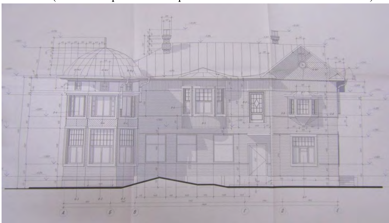
Илл. 28. Существующий фасад в осях А-Е (обмерный чертеж восточного фасада). 2015 г. (источник: архив КГИОП рег. № 01-26-403/17-0-0 от 30.01.2017 г.).
