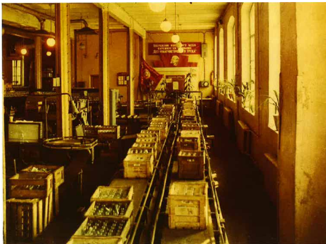
129. Транспортер сбора продукции с поточных линий розлива. История «ЛИВИЗа». Под общей редакцией Ю. А. Никулина. СПб, 2007
