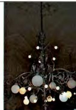
две люстры на 20 светоточек – материал (металл, матовое стекло), техника исполнения (литье, ковка, тонировка), конструкция и оформление (в виде спиралевидных завитков с растительным декором, плафоны - большие и малые шары, в виде колокольчиков, кронштейны верхнего яруса загнуты книзу, со спиралевидными завитками и листьями аканта, с завершением в виде короны из акантовых листьев);
