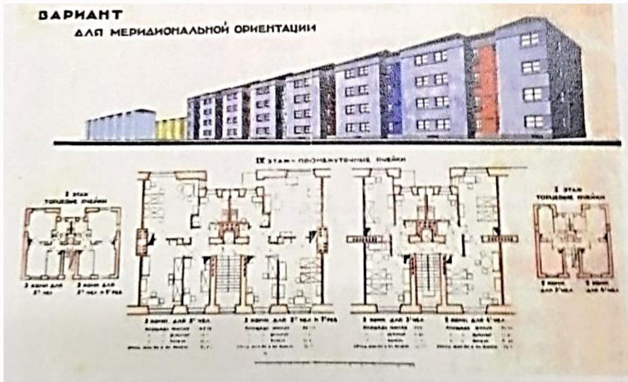
Илл.14. Перспектива фасадов по Кондратьевскому проспекту. Планы 1 этажа секции жилого дома с размещением торцевых ячеек. Планы 4 этажа секции жилого дома с размещением промежуточных ячеек. Вариант с печным отоплением (2 премия). Конкурсный проект под девизом «Даешь лифт!». 1928 г. Д.П. Бурышкин, Л.М. Тверской, Л.Д. Аكوпова, О.И. Руднева, при участии Н.Д. Каценеленбогена. ГМИ. СПб, Инв. № 1-Б-4743-ч. Кат. №152.
