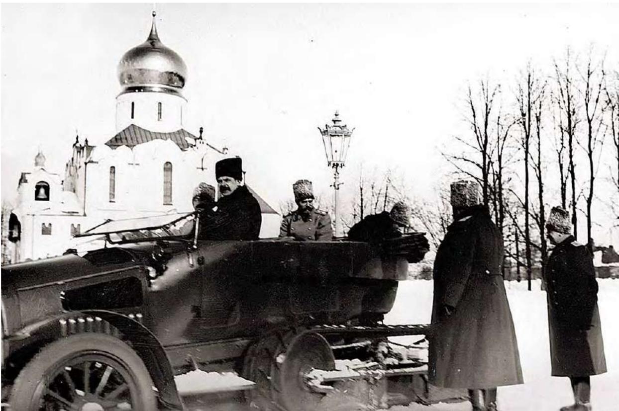
*Илл. 21. Испытания полугусеничного автомобиля «Руссо-Балт С 24/40». 1914-1915.*
