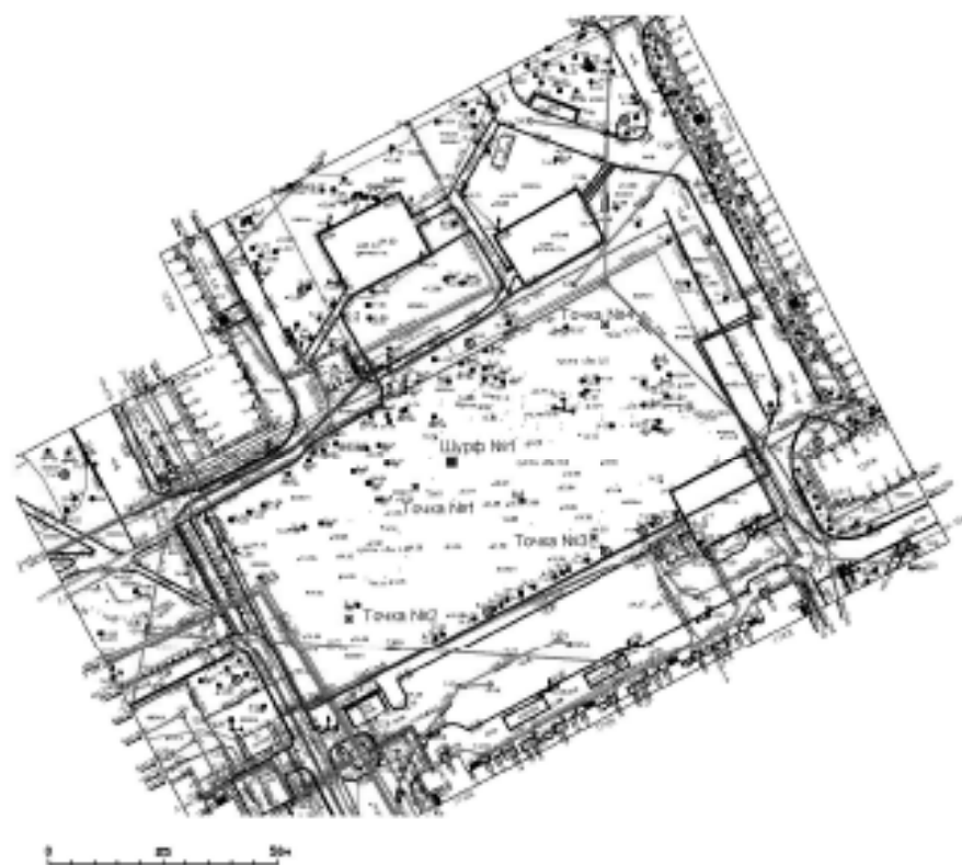
Рис.15. Топографический план участка обводнения, предоставляемый заключением работ, с нанесением на него археологическим шурфом и точками съемки. Масштаб 1:1000.
