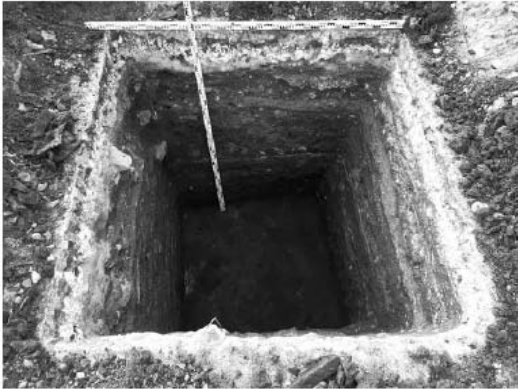
Рис. 208. Санкт-Петербург, «Строительство Красносельско-Калининской линии от станции «Казаковская» до станции «Обводный канал-2» с электродепо «Красносельское». Участок обследования «Строительная площадка вестибюля № 2 станции «Боровая». Строительная площадка шахты № 850 по адресу: Фрунзенский район, Лиговский проспект, дом 26, литера И». Шурф 1. Фотофиксация слоя темно-коричневой мешаной супеси 1. Вид на северо-запад.
