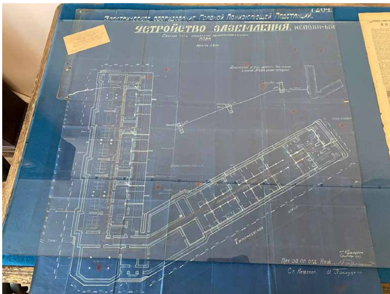
35. План здания главной понижающей подстанции с устройством заземления. – Материалы экспозиции музея подстанции «Волхов-Северная»
