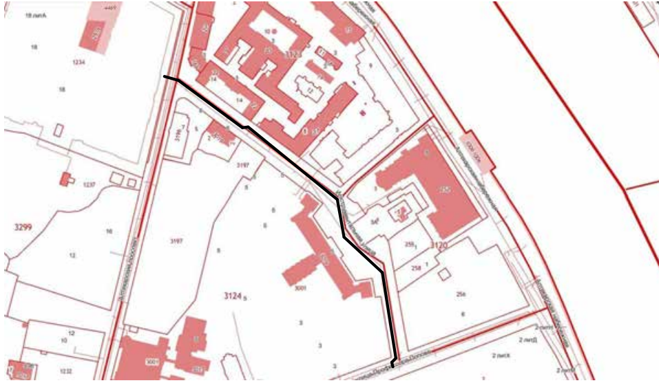
Схема расположения объекта "водопроводная сеть для подключения: Многоквартирного жилого дома по адресу: Санкт-Петербург, Аптекарский проспект, дом 5, литера А" на публичной кадастровой карте РФ
