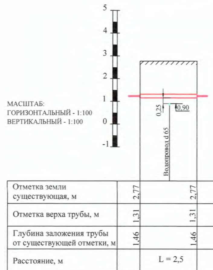
Пересечение №37 1 труба ПЭ d 160 L= 2,5 м
