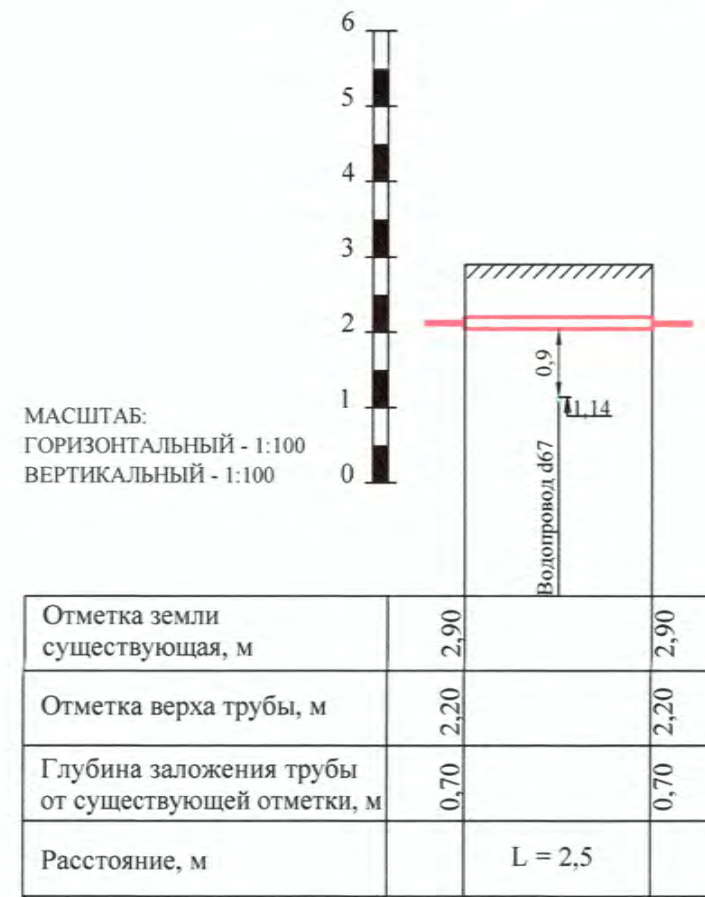
Пересечение 34 1 труба ПЭ d 160 L= 2,5 м
