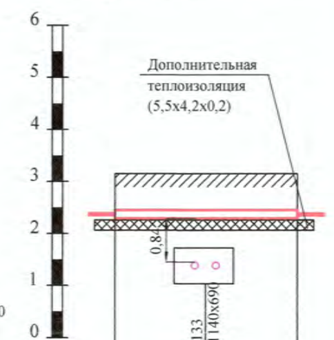
Пересечение №66 3 трубы ПЭ д 160 L= 3,5 м
