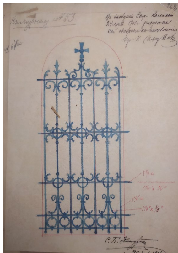
Илл. 43. Рисунок решетки для установки в оконный проем Покровско-Коломенской церкви. С. Г. Кондратьев. Одобрен Строительной комиссией 24 января 1901 г. // ЦГИА СПб. Ф. 278. Оп. 1. Д. 47а. Л. 268.
