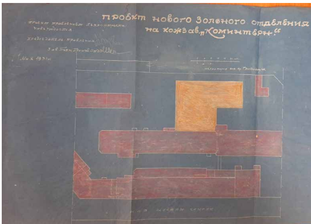
Илл. 41. Фрагмент генерального плана кожевенного завода «Коминтерн». Проект нового зольного отделения. На плане — оранжевого цвета. 1931 г. ЦГА СПб. Ф. Р-4370. Оп. 2. Д. 774. Л. 5.
