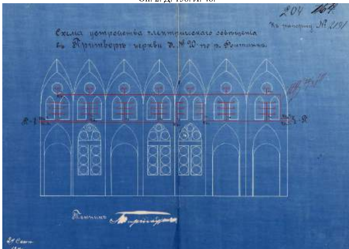
26. Схема устройства электрического освещения в притворе церкви д. № 20 по Фонтанке. 1911 г. РГИА. Ф. 475. Оп. 2. Д. 158. Л. 48
