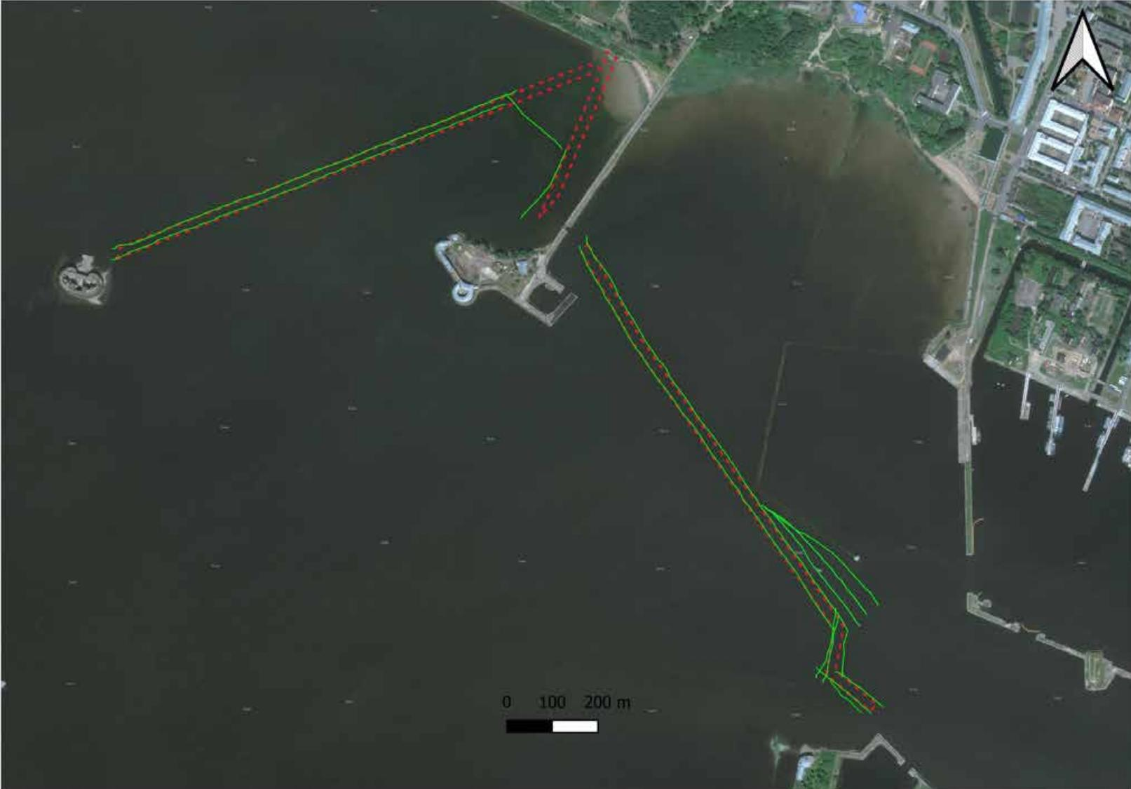
Рис. 79. Кронштадт – 2023. Схема линий фактического движения носителя при проведении съемки ГБО.
