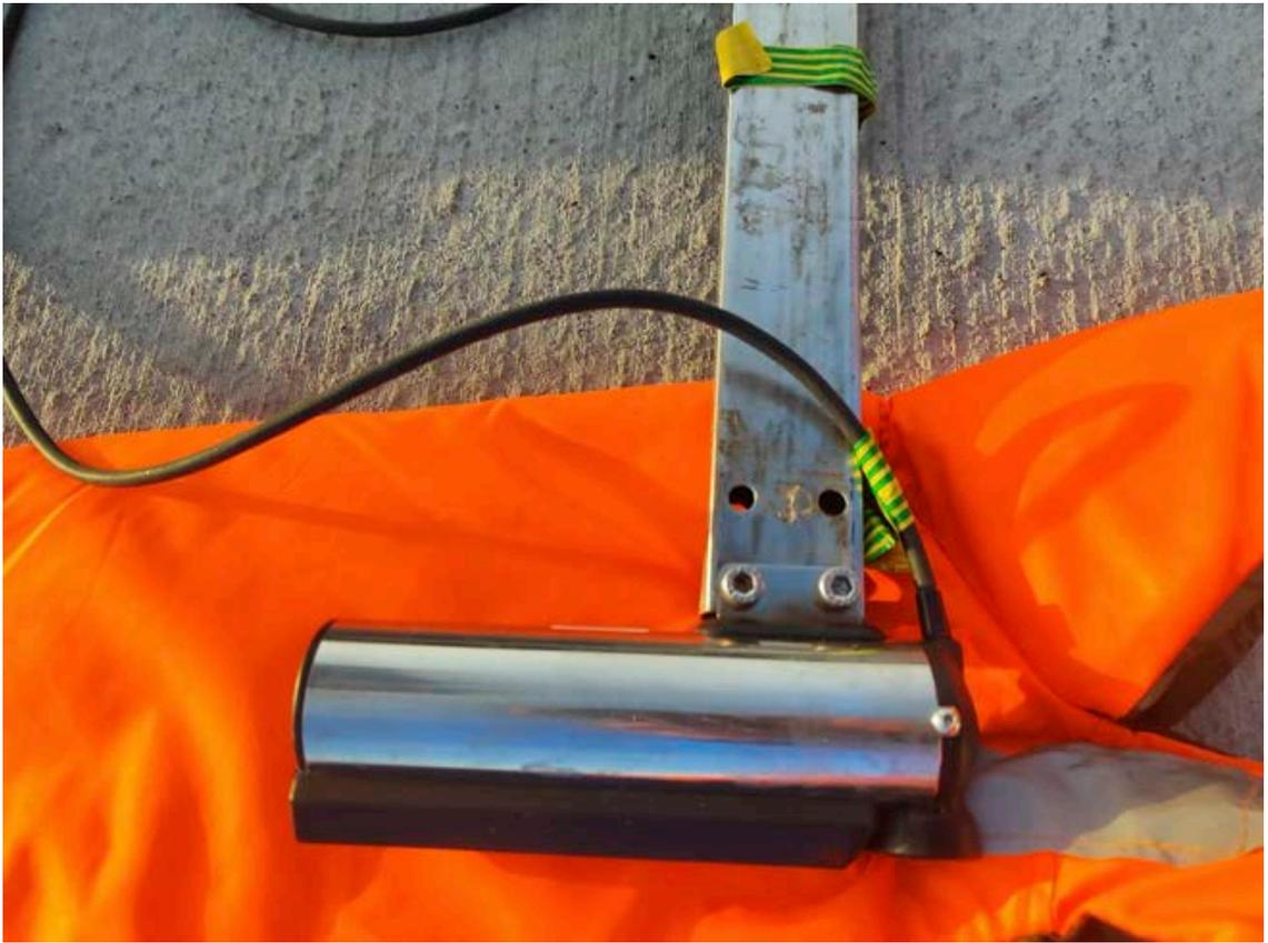
Рис. 48. Кронштадт – 2023. Гидролокатор бокового обзора H5se7.
