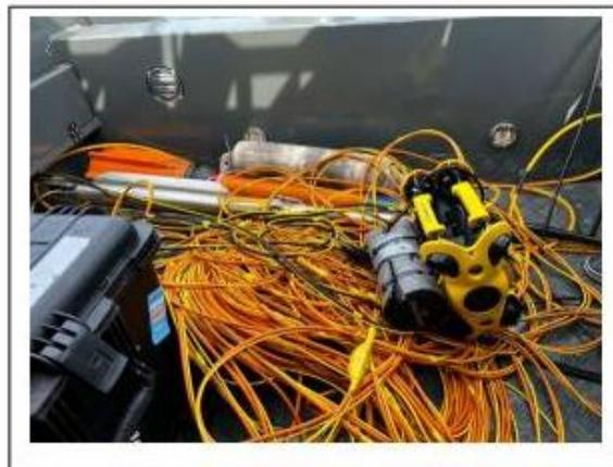
Рис. 12 ТПА с сонаром секторного обзора
