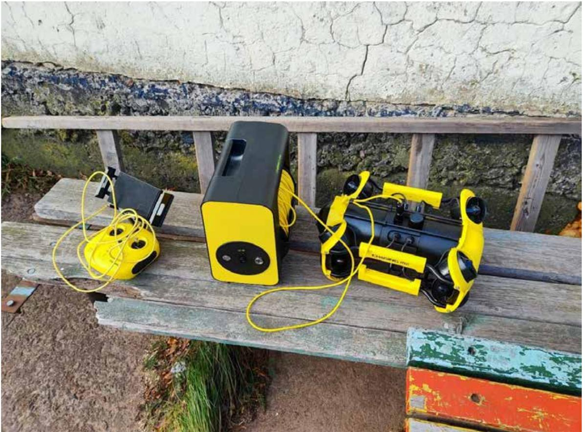
Рис. 58. Кронштадт – 2023. ТНПА осмотрного класса «Chasing M2».
