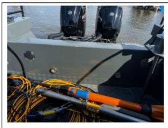
Рис. 11 ГБО и магнитометр
