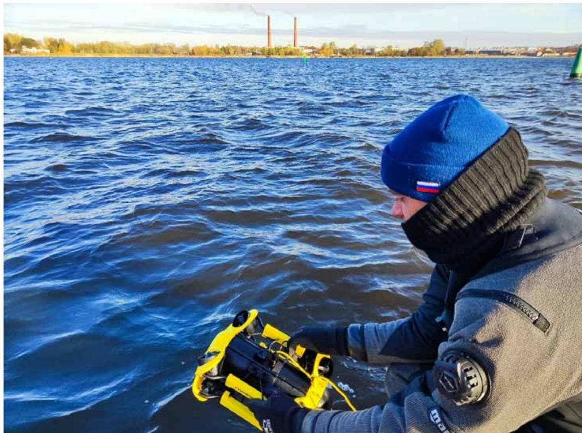
Рис. 61. Кронштадт – 2023. Работа с ТНПА осмотрового класса «Chasing M2».
