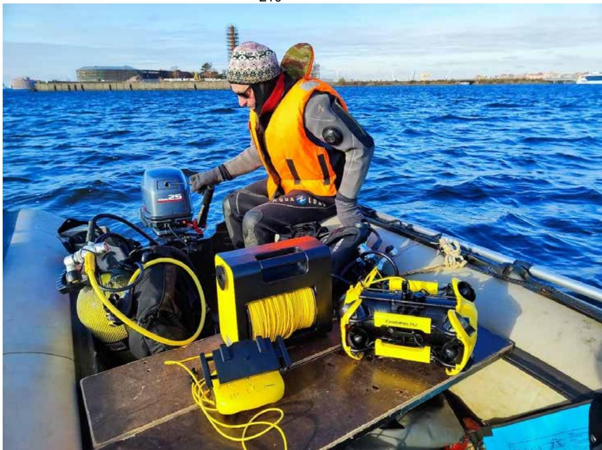
Рис. 60. Кронштадт – 2023. Работа с ТНПА осмотрового класса «Chasing M2».
