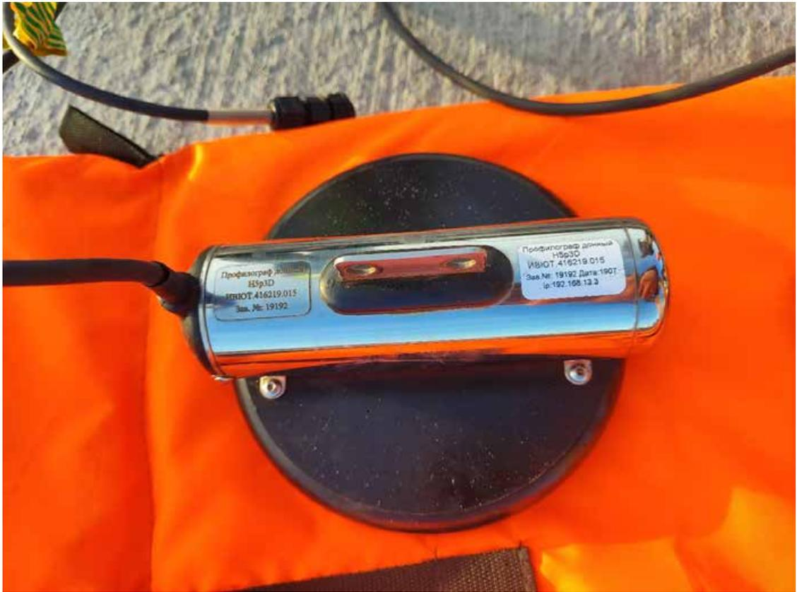
Рис. 52. Кронштадт – 2023. Профилограф донный Н5р3D.
