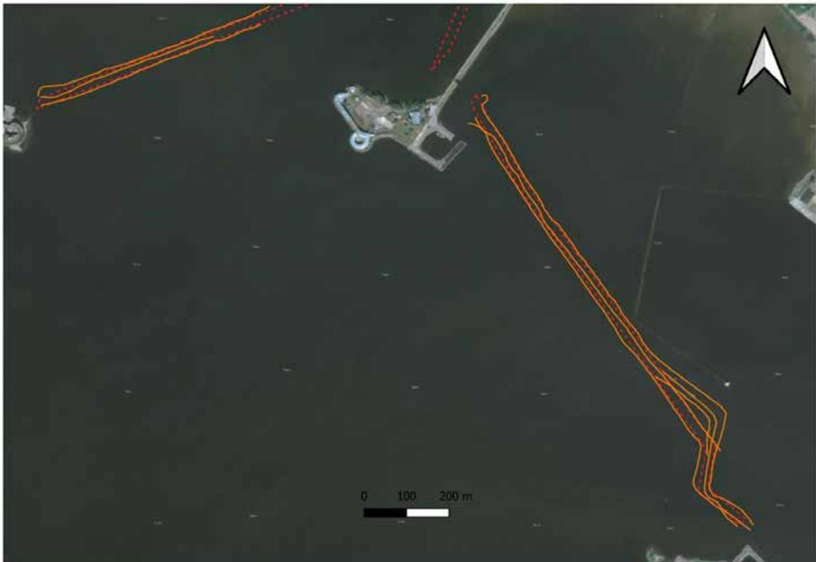
Рис. 119. Кронштадт – 2023. Схема линий фактического движения носителя при проведении морской магнитной съемки.
