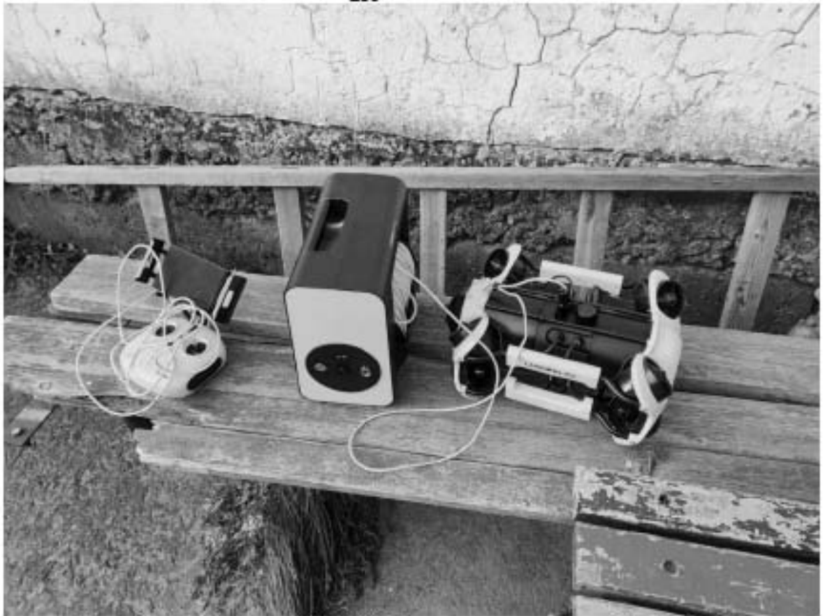
Рис. 65. Кронштадт – 2023. ТНПА осмотраого класса «Chasing M2».
