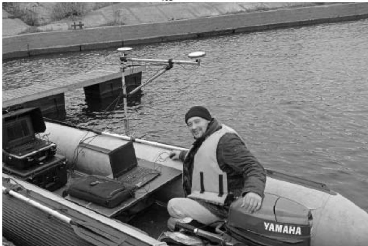
Рис. 49. Кронштадт – 2023. Монтаж навигационного оборудования.
