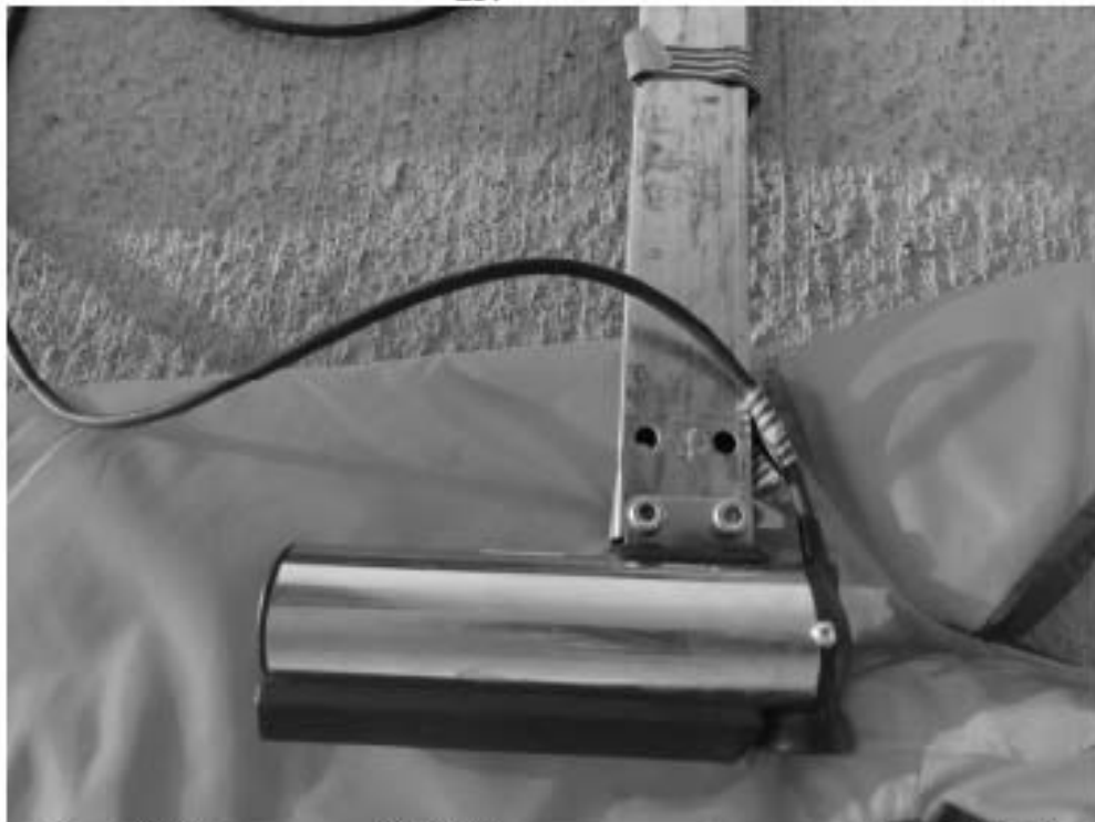
Рис. 55. Кронштадт – 2023. Гидролокатор бокового обзора H5se7.
