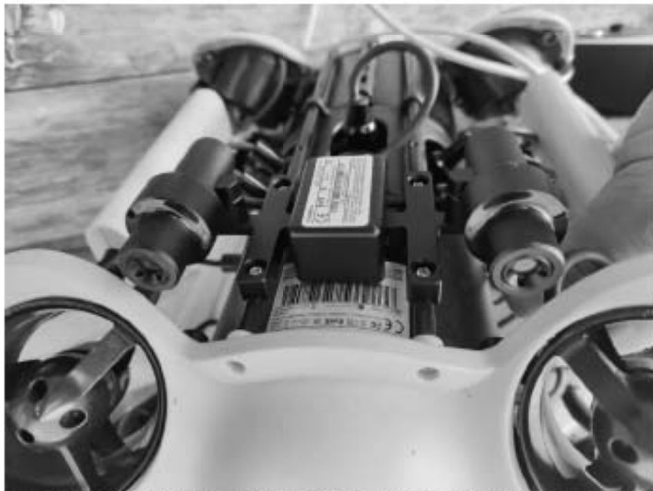
Рис. 66. Кронштадт – 2023. Лазерные указатели на ТНПА осмотраого класса «Chasing M2».
