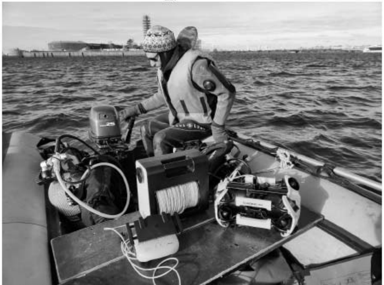
Рис. 67. Кронштадт – 2023. Работа с ТНПА обзорного класса «Chasing M2».
