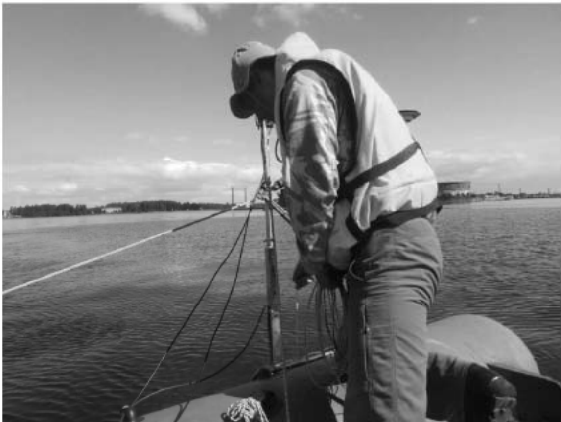
Рис. 54. Кронштадт – 2023. Форт «Александр I». Тарирование (калибровки) зхолота на мелководье.
