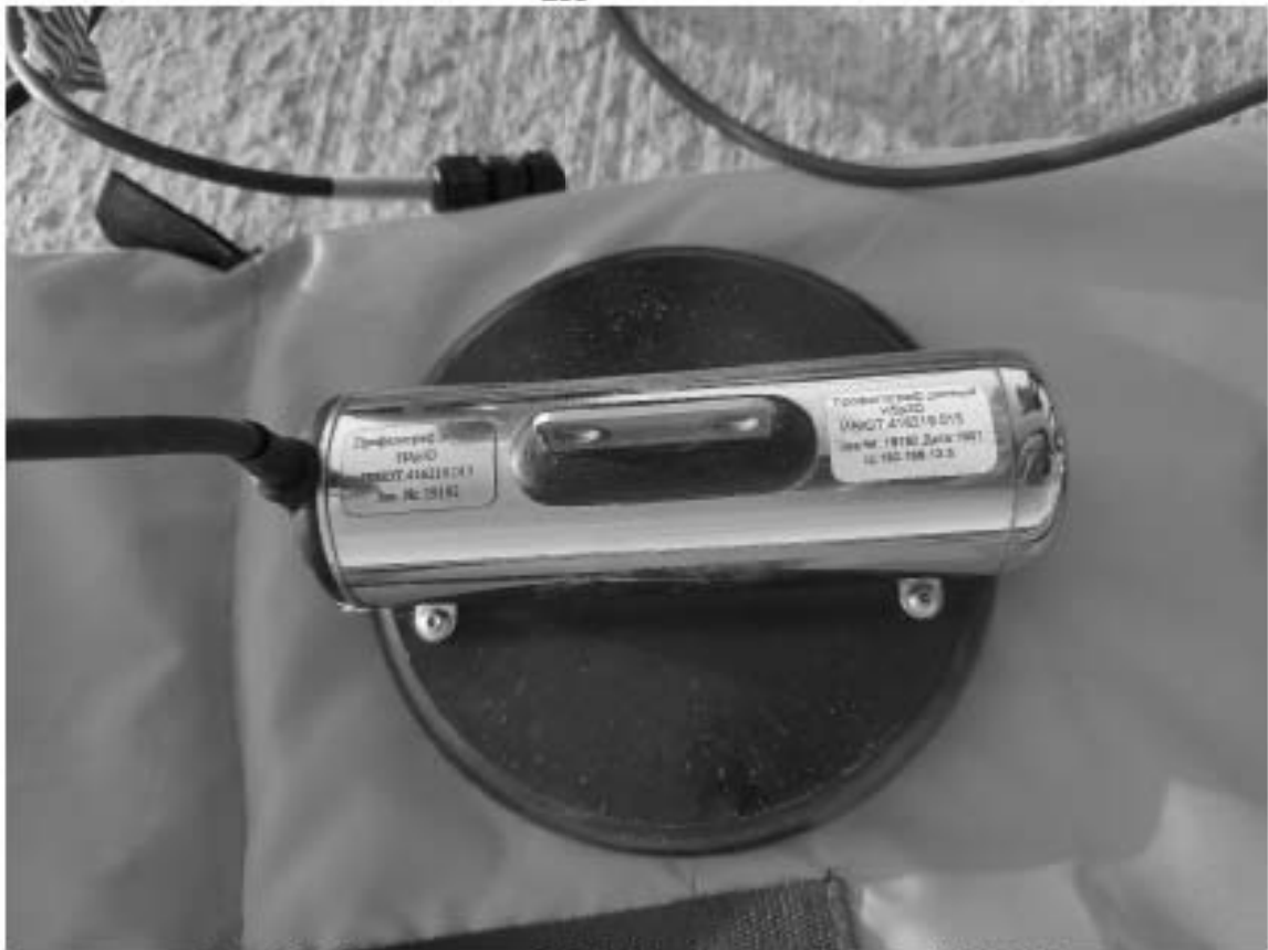
Рис. 59. Кроншгадт – 2023. Профилограф донный Н5р3D.
