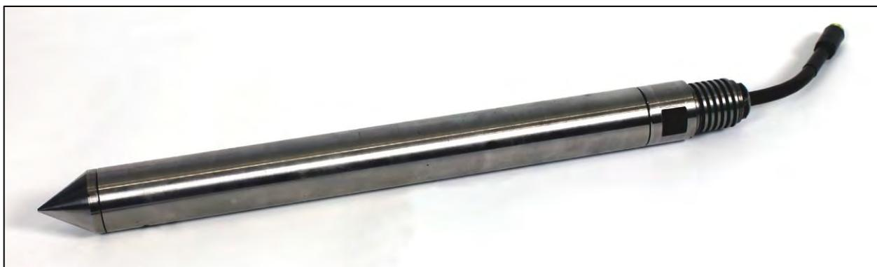
Рисунок 4.3 – Общий вид тензометрического зонда
