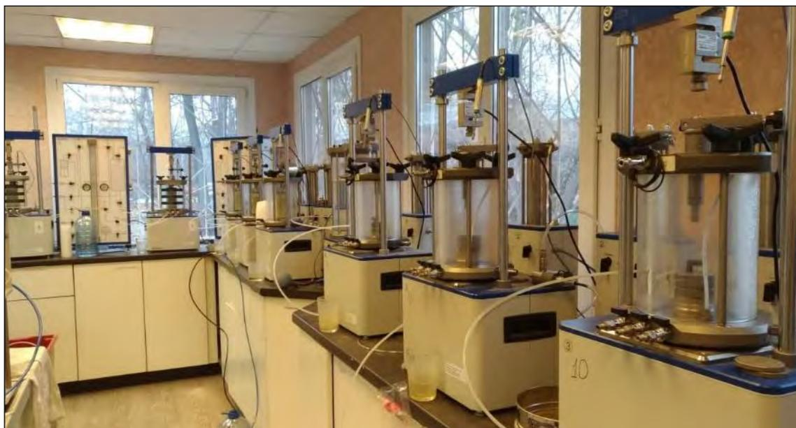
Рисунок 4.23 – Прибор для испытаний грунта методом трехосного сжатия
