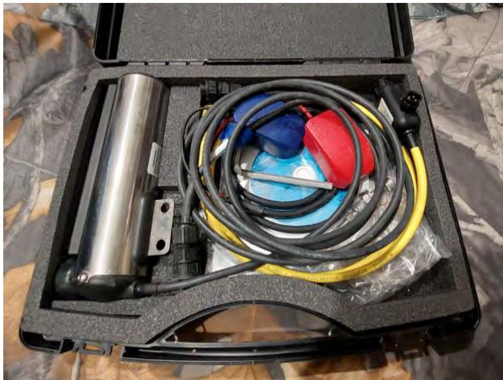
Рисунок 4.5 – Моноблок гидролокатора H5se7
