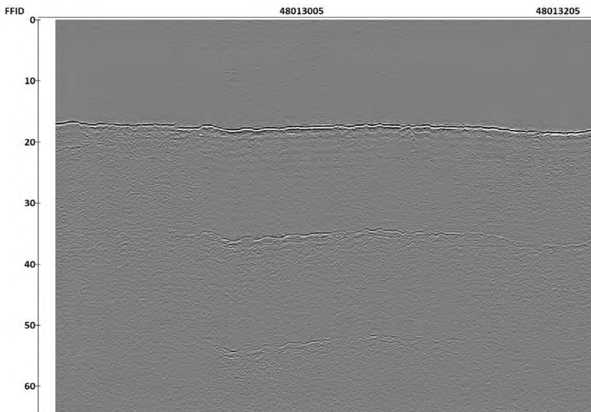
Рисунок 12.12 – Пример данных НСП после подавления нерегулярных помех
