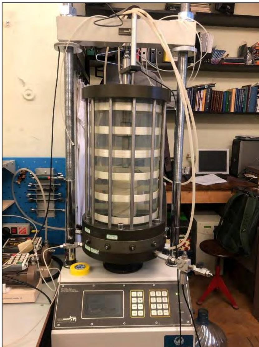
Рисунок 4.24 – Приборы для испытаний методом циклических трехосных сжатий
