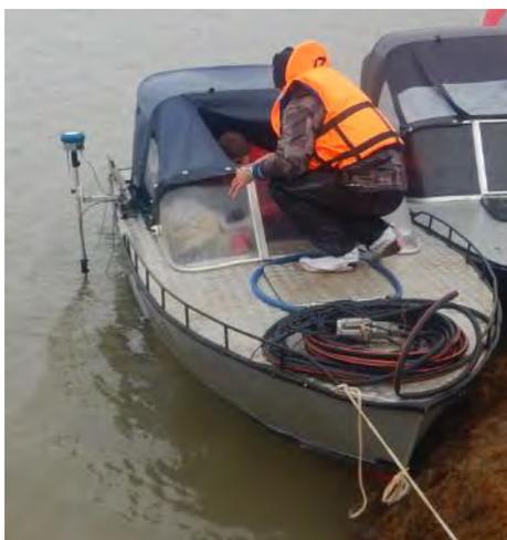
Рисунок 4.8 – Схема установки ГЛБО H5se7
