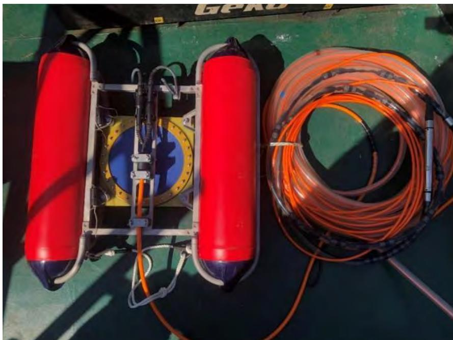
Рисунок 4.14 – Комплект геофизического оборудования для проведения НСП
