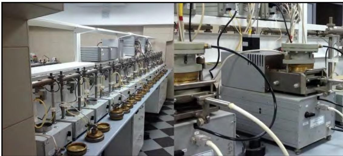
Рисунок 4.22 – Группа приборов для компрессионных (а) и сдвиговых испытаний грунтов (б)
