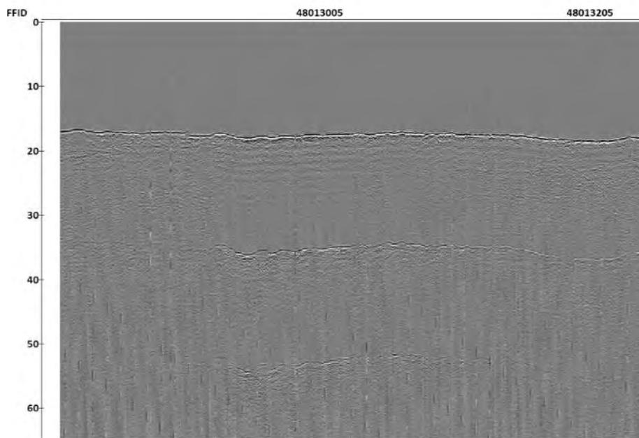
Рисунок 12.8 – Пример сейсмограммы нулевого удаления с введенной амплитудной коррекцией (слева).
