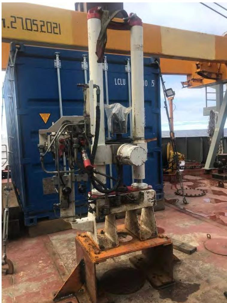
Рисунок 4.4 – Установка статического зондирования
