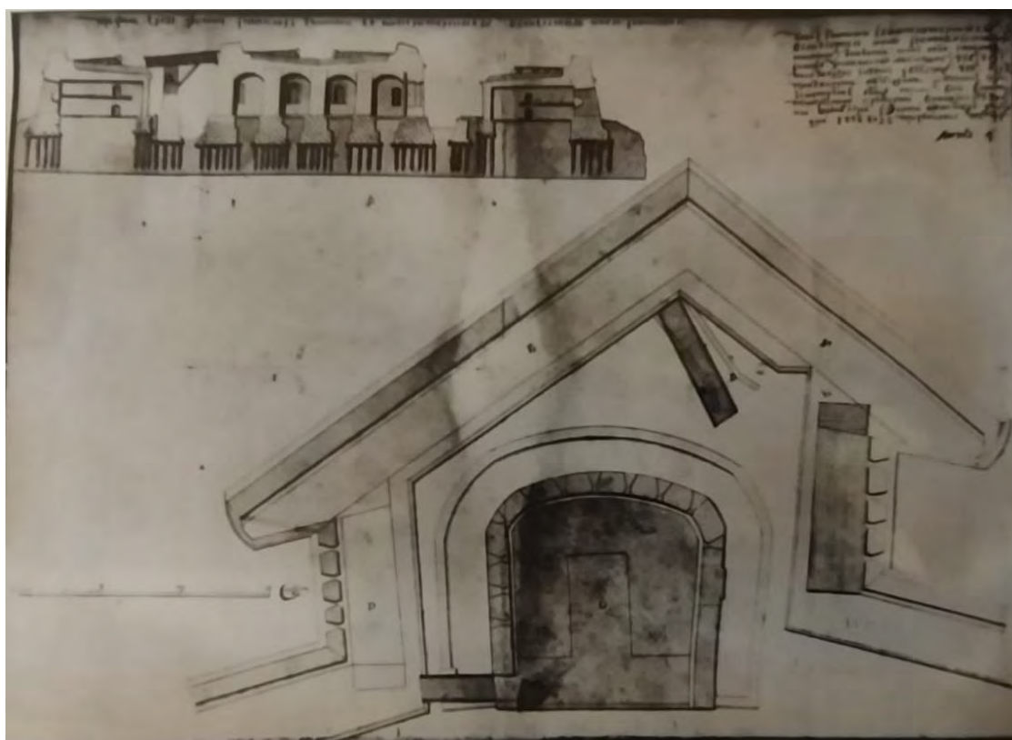
Илл.17. План и разрез бастиона с кавальером. 1750. РГА ВМФ. Копия: КГИОП, п. 90-17 (1) Н 1088.
