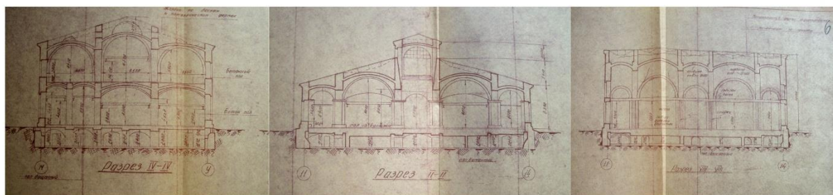
26. Разрезы лафетной мастерской с северным отделом центральной дворовой части (бывшее помещение «сверлильной и цапфельной машины»), не пострадавшей от бомб во время войны. Обмерные чертежи 1955 г. Архив отдела главного архитектора при заводе «Арсенал». (Фрагмент).
