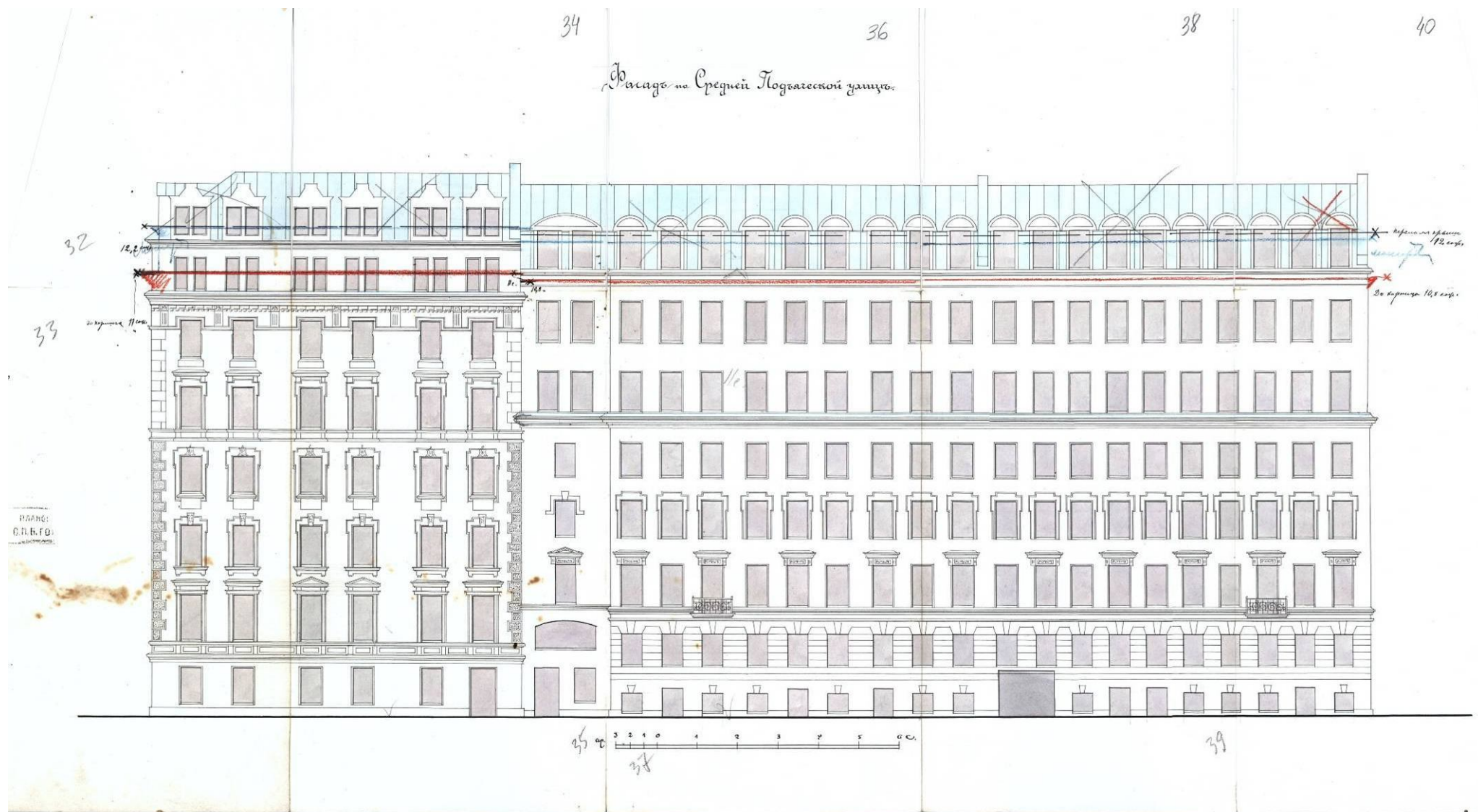
Илл. 39. Фасад по Средней Подьяческой ул. с исправлениями согласованной в 1910 г. постройки. 1916 г. ЦГИА СПб Ф.515. Оп.4. Д.4275. Л. 32-41.
