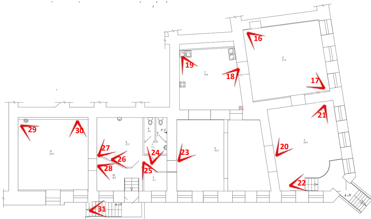
Рисунок 2. Схема фотофиксации на фрагменте плана подвала
