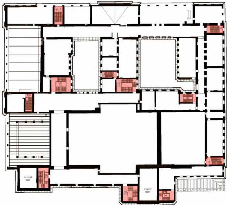
План 5 этажа с указанием местоположения лестниц
