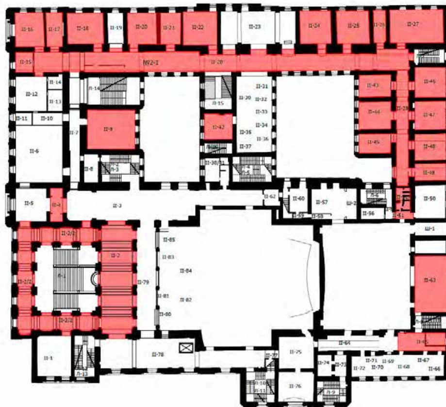
Схема 2 этажа с указанием помещений с охраняемыми перекрытиями
