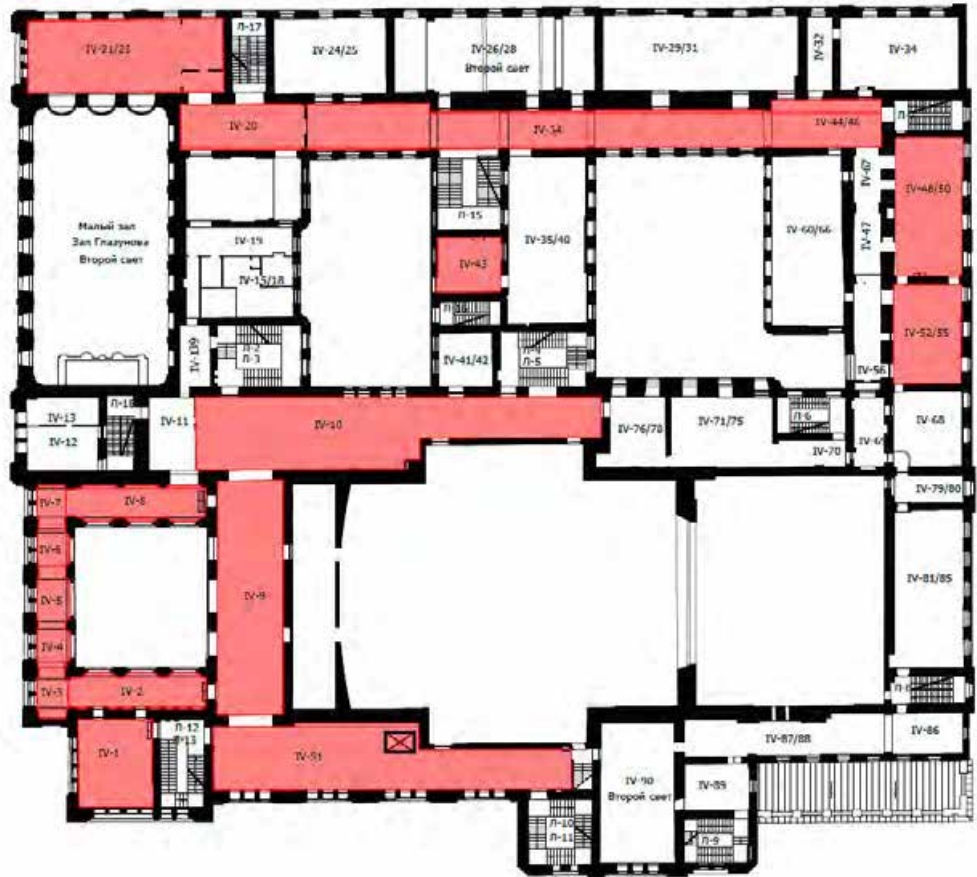
Схема 4 этажа с обозначением помещений, где расположены печи
