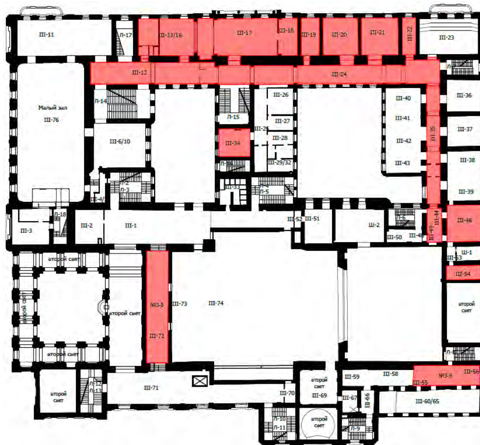
Схема 3 этажа с указанием помещений с охраняемыми перекрытиями
