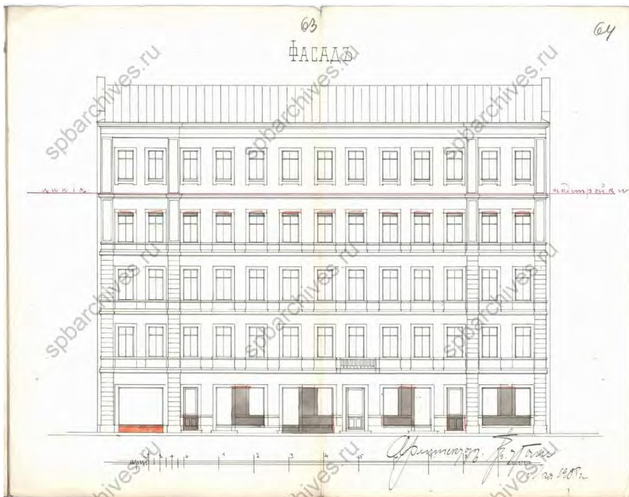
21. «Фасад» Проект реконструкции флигелей Дома Дмитрия и Федора Лаврентьевичей Парфеновых. Раскрытие витринных окон на первом этаже лицевого фасада. Архитектор Г.Г. фон-Голи. 1908г. ЦГИА СПб Ф.513. Оп 102. Д.7306
