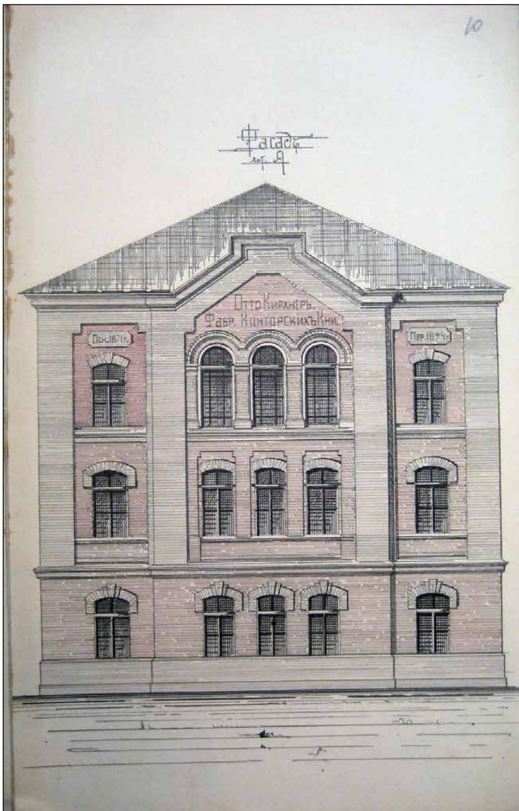
11. Фасад предполагаемого к постройке производственного корпуса (лит. А).
