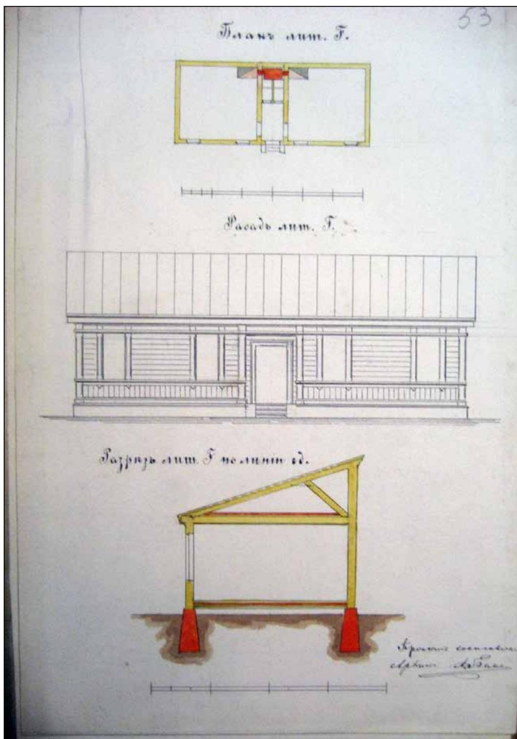
31. План, фасад и разрез по линии с-d помещения для машинного отделения (лит. F). 1897 г. // ЦГИА СПб. Ф. 513. Оп. 102. Д. 8363. Л. 53.
