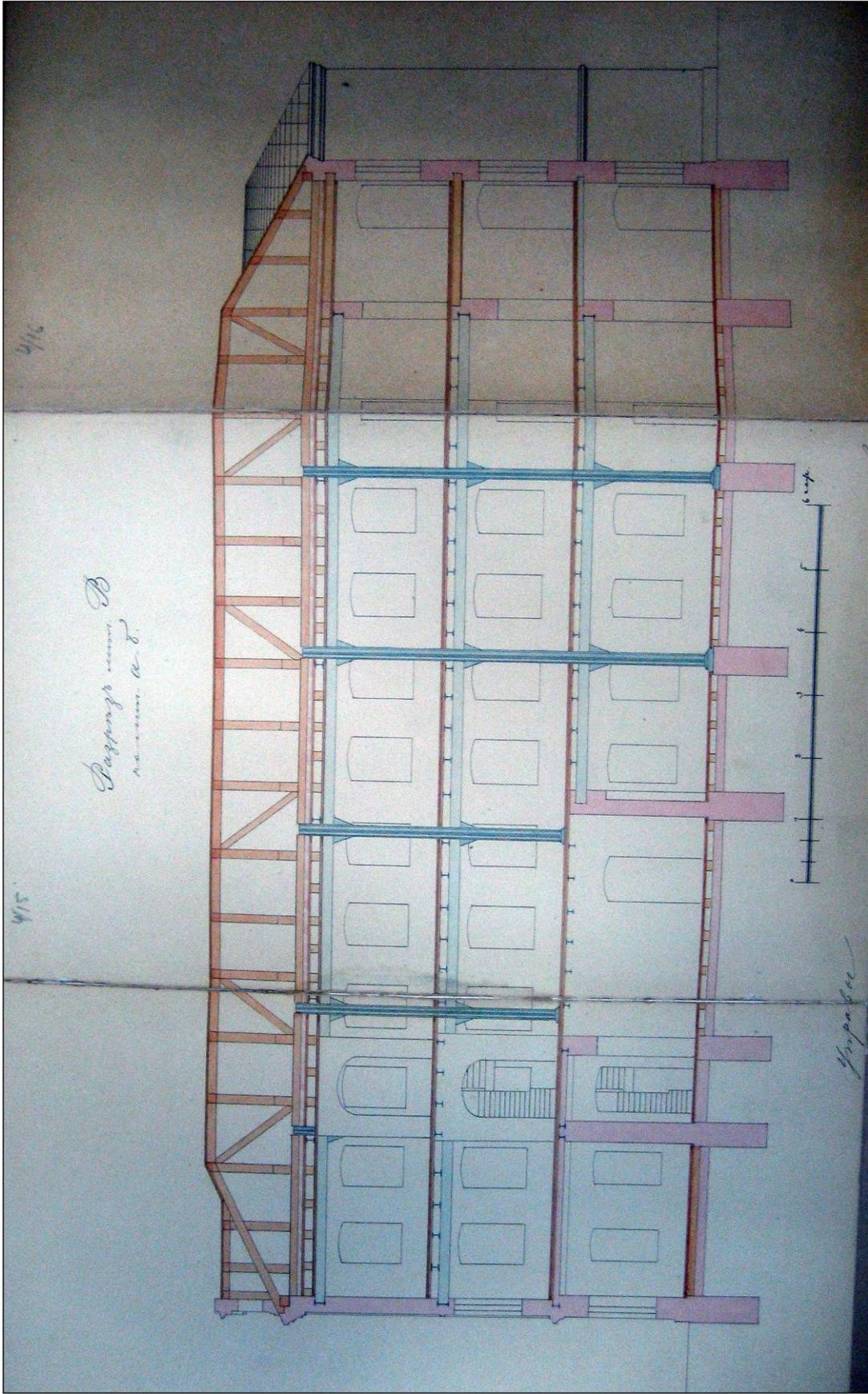
19. Разрез по линии а-б производственного корпуса (в настоящее время – корпус лит. В). 1895 г. // Архив фабрики «Светоч». Папка № 29.
