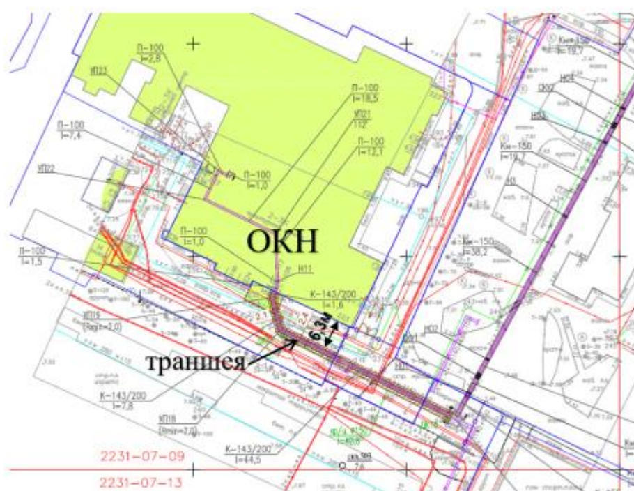
Рис. 3. Схема расположения траншеи относительно ОКН
