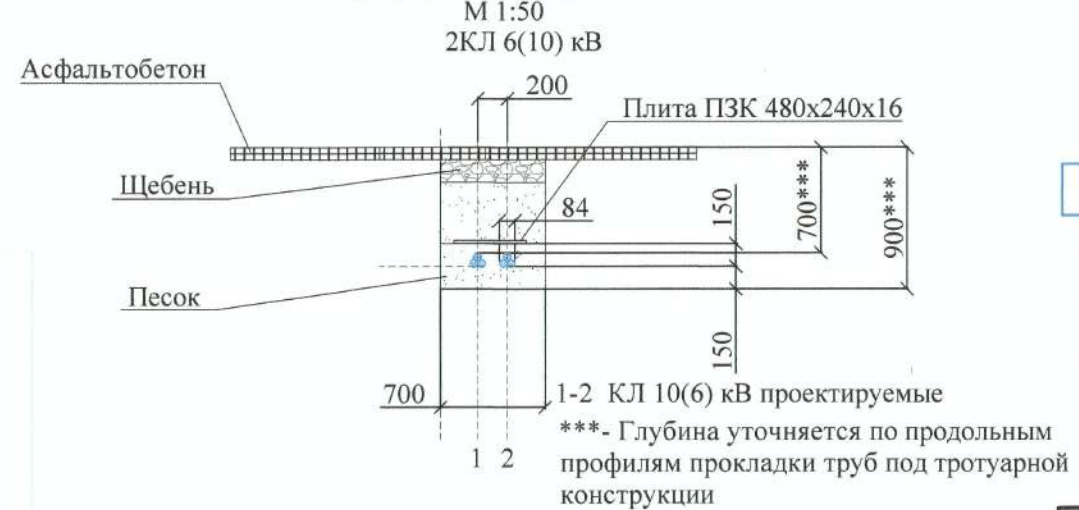
Разрез траншеи при прокладке 2 КЛ 6 (10) кВ под тротуарной конструкцией.
