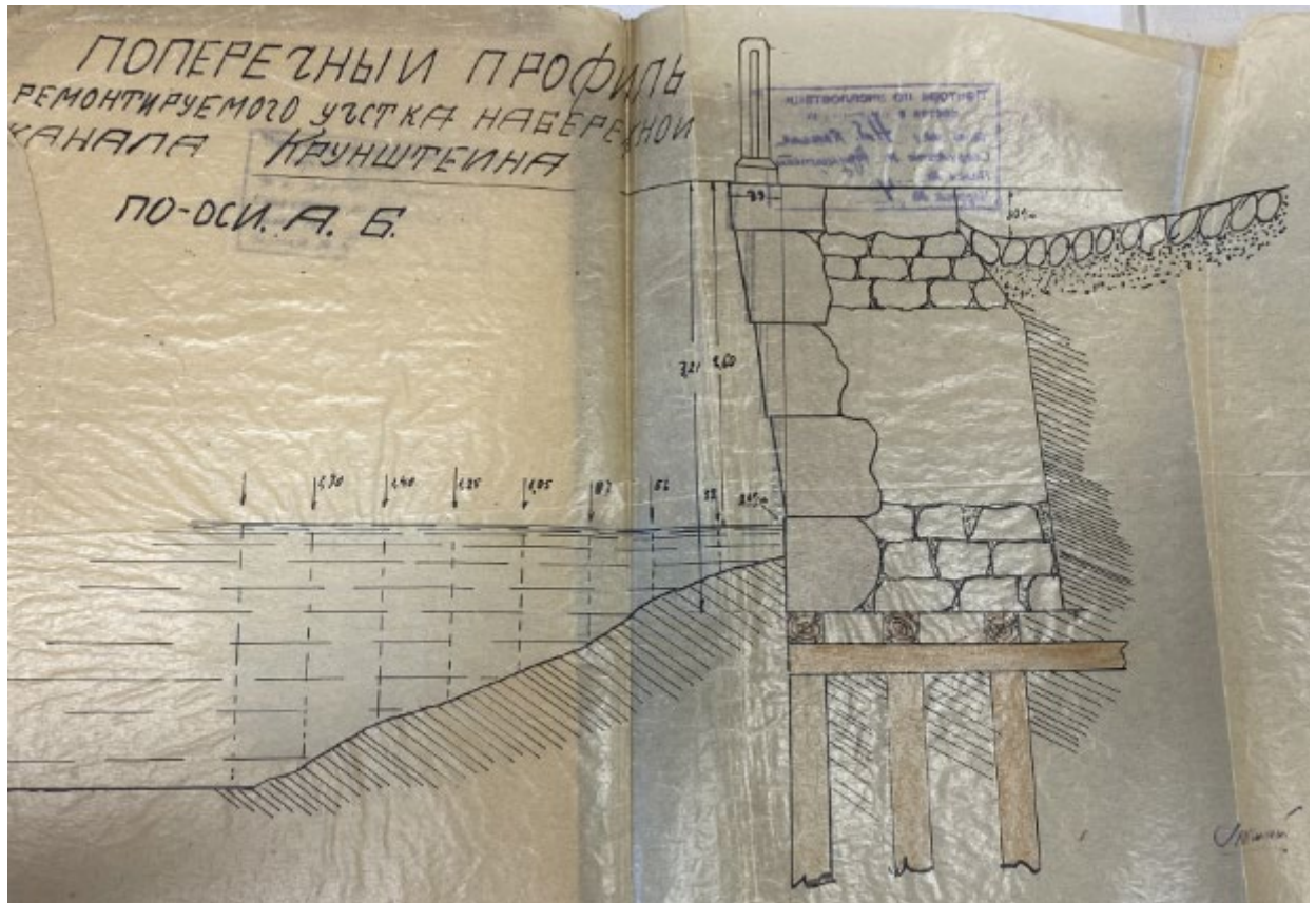
Илл. 20. Проект ремонта каменной части набережной. Деформированный участок. Разрез. 1934 г. (Архив СПб ГБУ «Мостотрест»)
