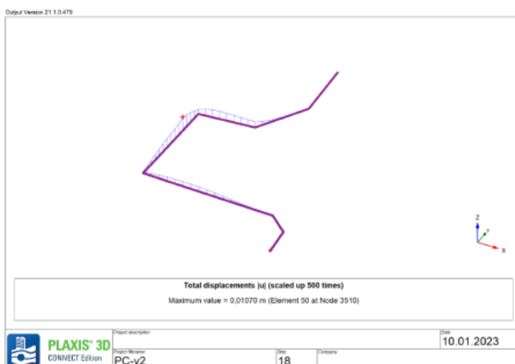
Полные деформации водопровода
