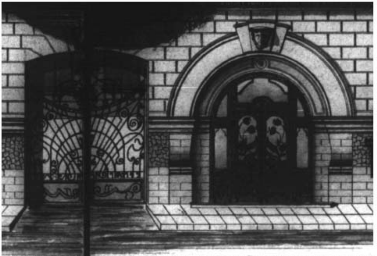
Илл. 35. Главный фасад лицевого корпуса. Фрагмент с дверным заполнением главного входа и металлические ворота арочного проезда во двор. ЦГИА СПб (Ф. 515. Оп. 4. Д. 2025. Лл. 20-21)
