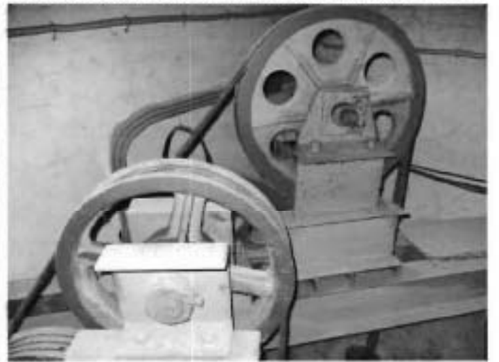
30. Конструкция подъемных дисков грузового лифта
