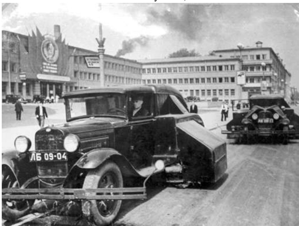
72. Уборка улиц у Московского райсовета. Подметально-уборочная машина "ПУ-7" на шасси ГАЗ-ММ. 13 июня 1938 г. «PastVu» — ретро-фотографии стран и городов [Электронный ресурс]. URL: https://pastvu.com/p/118918
