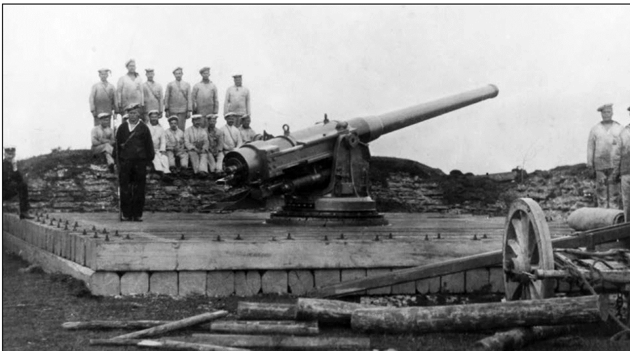
Илл. 18. 6-дм орудие Канэ на одной из батарей крепости Императора Петра Великого. 1914-1915 гг. Воспроизводится по изданию: Амирханов Л.И., Ткаченко В.Ф. Форт «Константин». СПб. 2014. С. 117.
