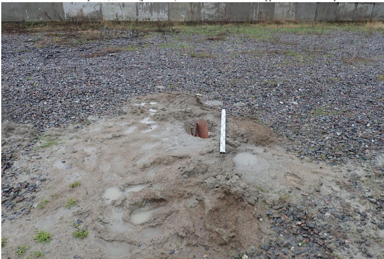
Рис. 15. Земельный участок с кадастровым номером 778:34:0004119:53 по адресу: г. Санкт-Петербург, Новосельковская улица, дом 31 (участок 1). Отвал геологического бура в центральной части участка.
