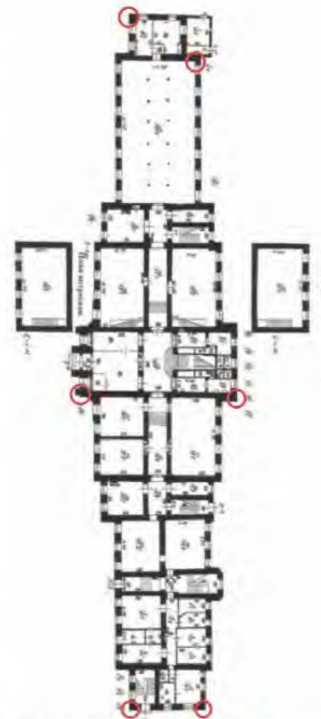
Рисунок 1 - Схема расположения поковых марок для здания по адресу: Университетская наб., дом 7-9-11, литера Ц
